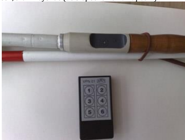
Obrázek 33 - 34: Akustický majáček, a VPN vysílač (ve slepecké holi a kapesní)
