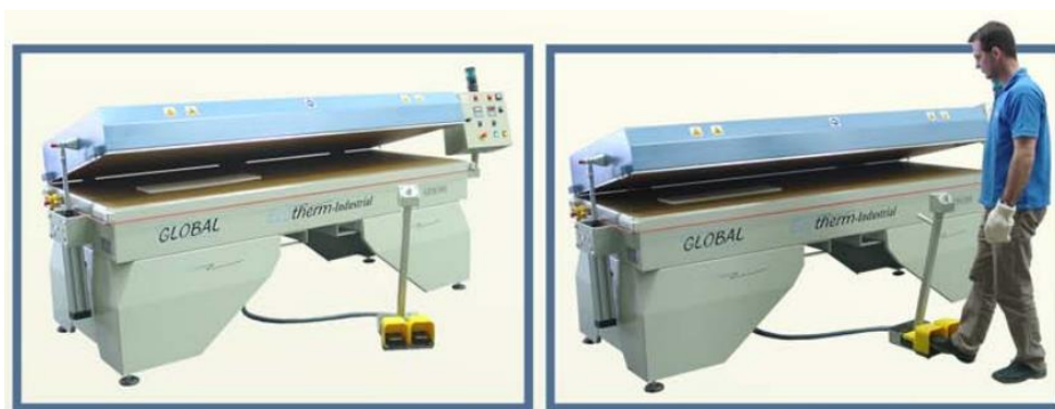
Obr. 23 Umístění umělého kamene typu Solid Surface do pece a následné uzavření pece pomocí pedálu [50]
