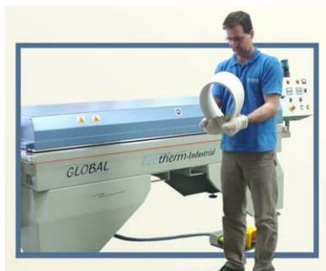
Obr. 25 Tvarování umělého kamene jde i lidskou silou velmi snadno [50]
