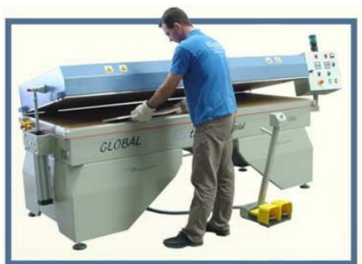
Obr. 24 Otevření pece pomocí pedálu. Vytáhnutí rozehřátého kusu umělého kamene z pece [50]
