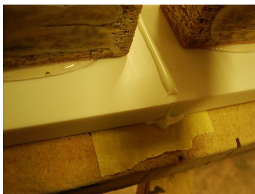
Obr. 29 Detail naneseného lepidla (vyfoceno v CETECHO s.r.o., 2015)
