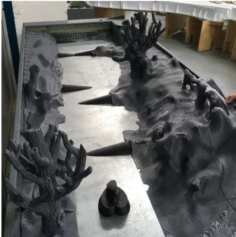
Obr. 8: Fyzický model budoucí slalomové dráhy v Kadani (zdroj: autor).
