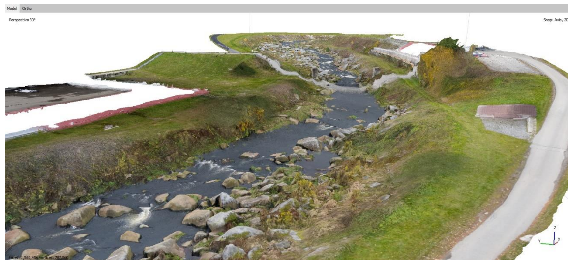
Obr. 15: Vytvořený TIN model s texturou (zdroj: autor).
