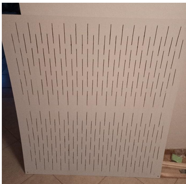
Obrázek 8 Zobrazení tvaru otvorů první desky
