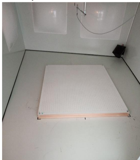
Obrázek 19 Měření vnitřního materiálu s vrchní deskou
