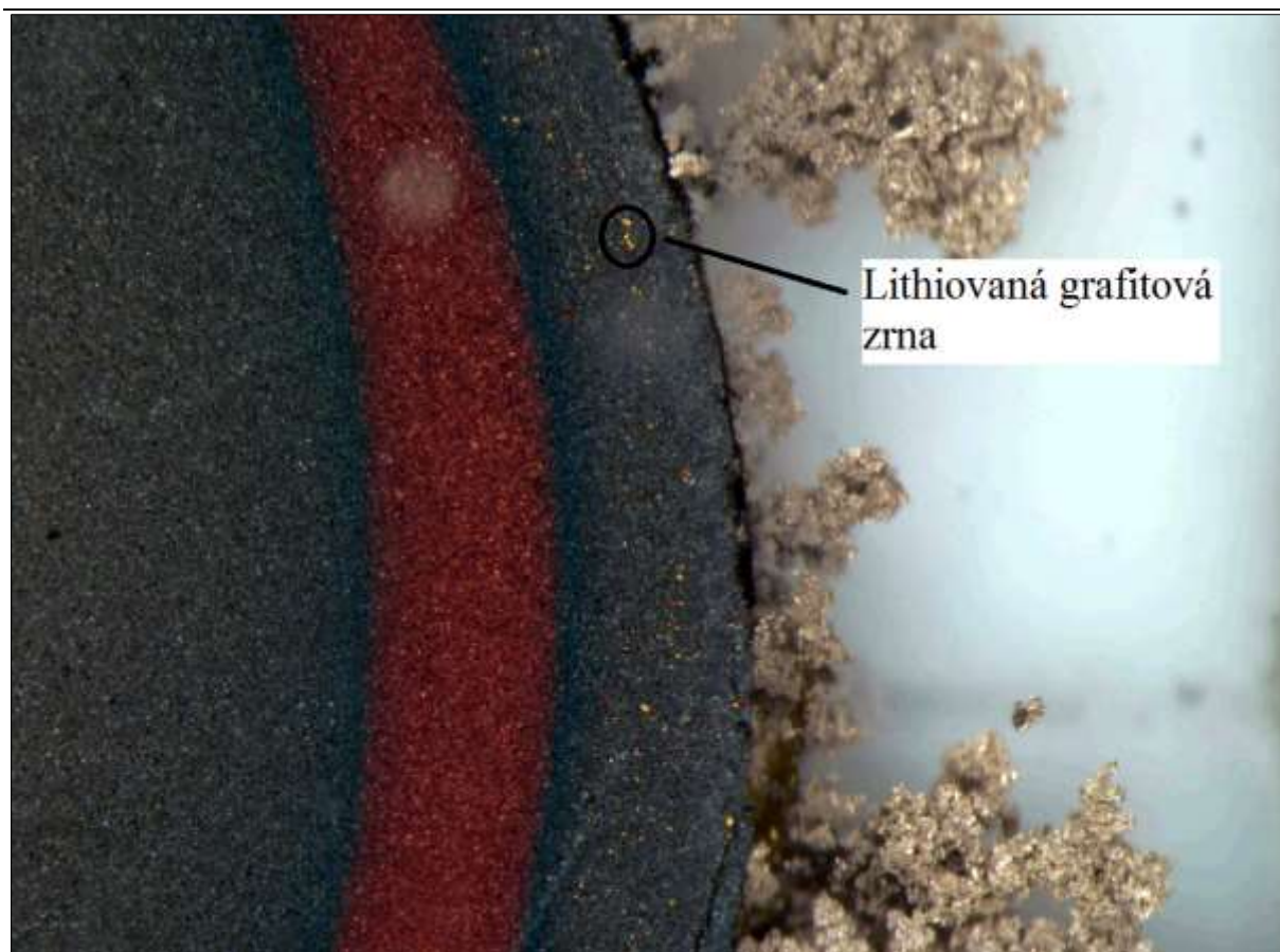
Obr. 29. Zrna grafitu, která vlivem objemových změn ztratila kontakt s elektrodou, tato zrna představují kapacitní ztráty elektrody. [67]
