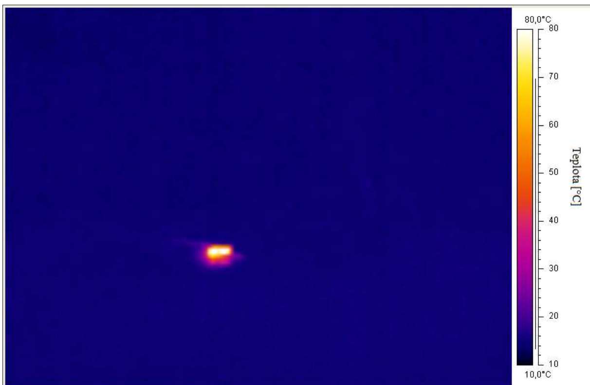
Obr. 102. Záznam monočlánku z termokamery zachycující ohřívající se povrch.
