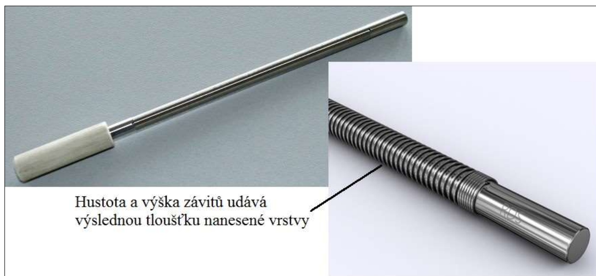
Obr. 37. Tyče pro vytváření vrstev elektrodového materiálu.[48]
