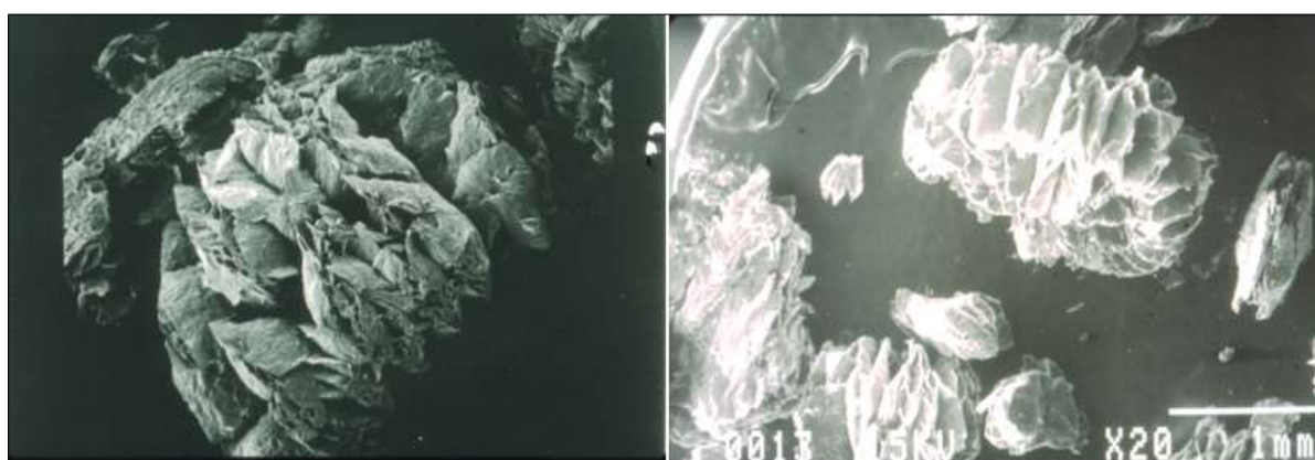
Obr. 8. Mikroskopické zobrazení částic expandovaného grafitu. [13]
