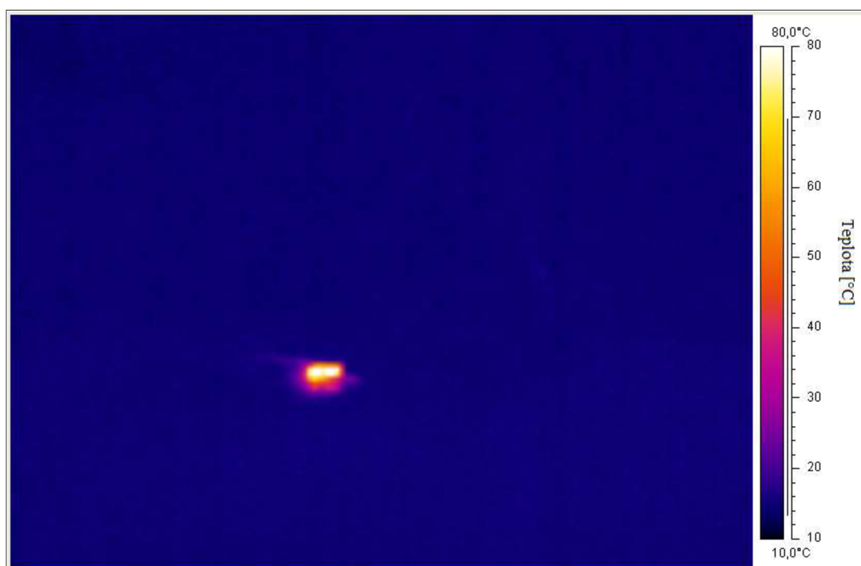
Obr. 102. Záznam monočlánku z termokamery zachycující ohřívající se povrch.
