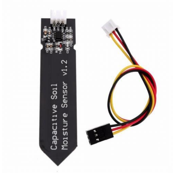
Obr. č. 3.13 - Analogový snímač vlhkosti půdy 57
