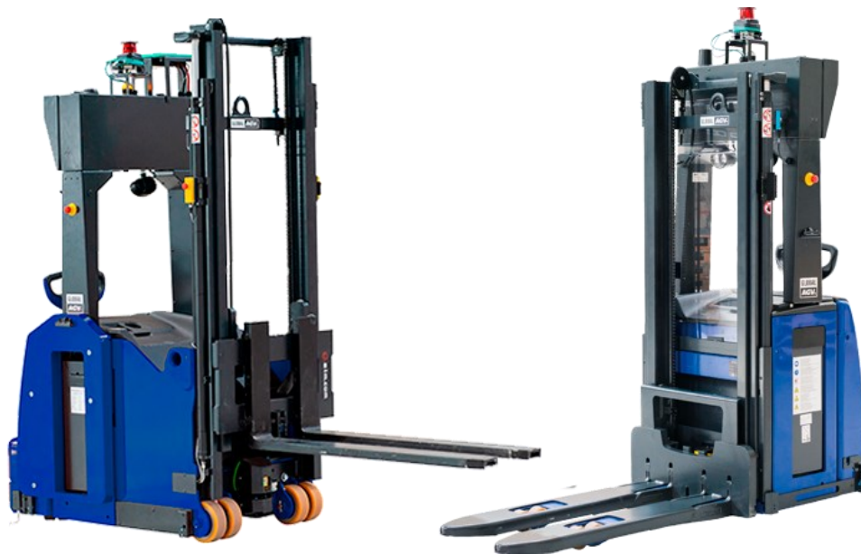
Obr. 2.9 AGV s vidlicemi zavěšenými na rámu a AGV s pevným rámem
