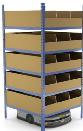
Obr. 2.15 Regálový systém s vlastní pevnou základnou
