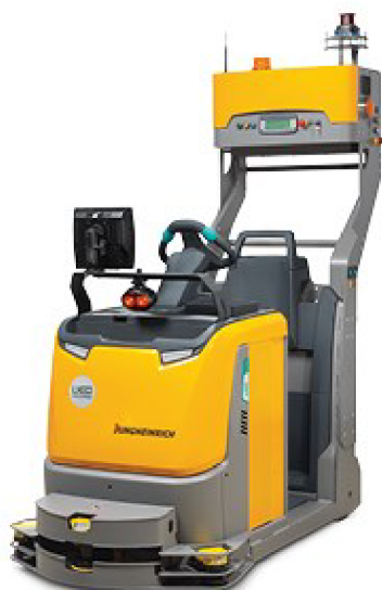
Obr. 2.8 Tažné AGV s možností provozu v manuálním režimu
