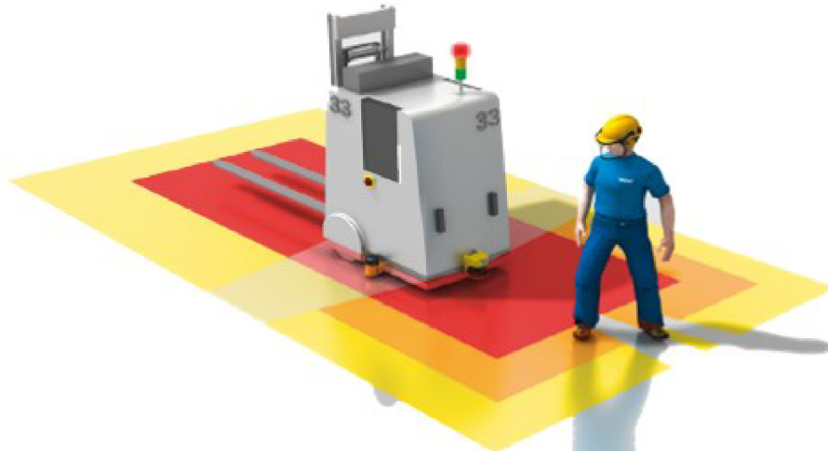
Obr. 1.7 Bezpečnostní zóny okolo AGV
