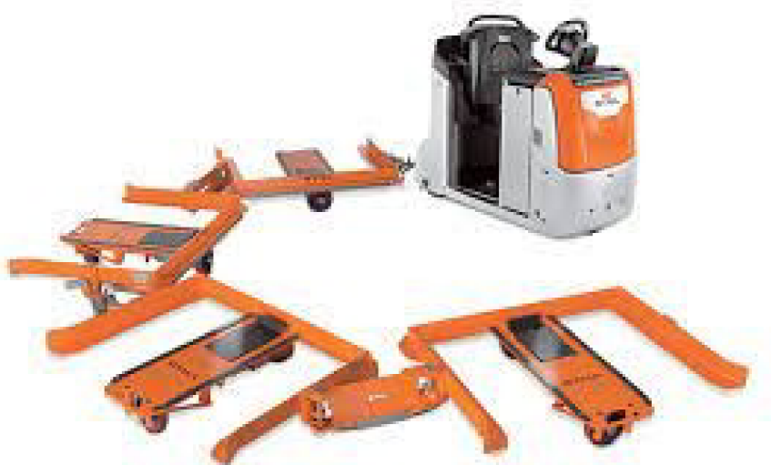
Obr. 2.13 Tažné vozidlo s připojenými E rámy
