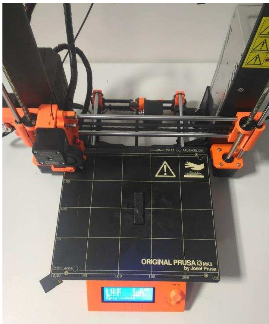
Obrázek 5.1 Ukázka 3D tiskárny ORIGINAL prusa i3 MK3 společně s vytištěným dielektrikem z PLA
