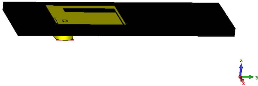
Obrázek 3.2 Model dvoupásmové PIFA antény, napájený koaxiální sondou.
