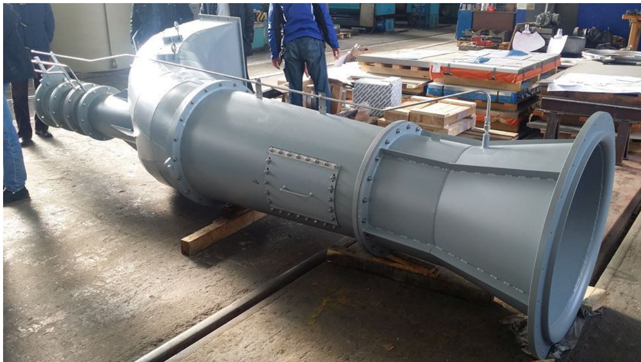
Obrázek 2.10: Část potrubí násoskové turbíny v Želině [23]
