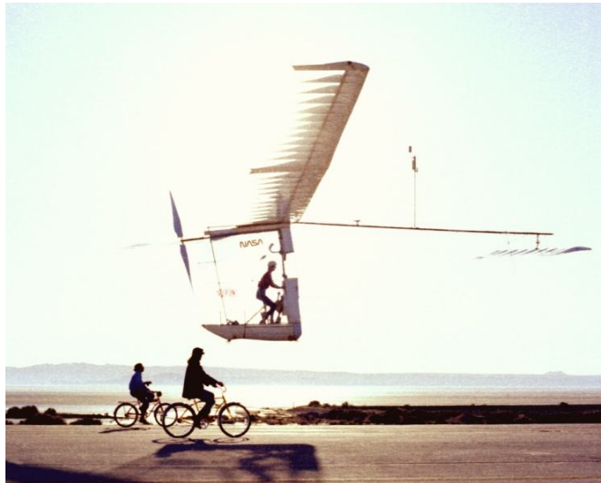
Obrázek 1.6: GossamerCondor, letoun s rozpětím křídel 29,25 m [1]
