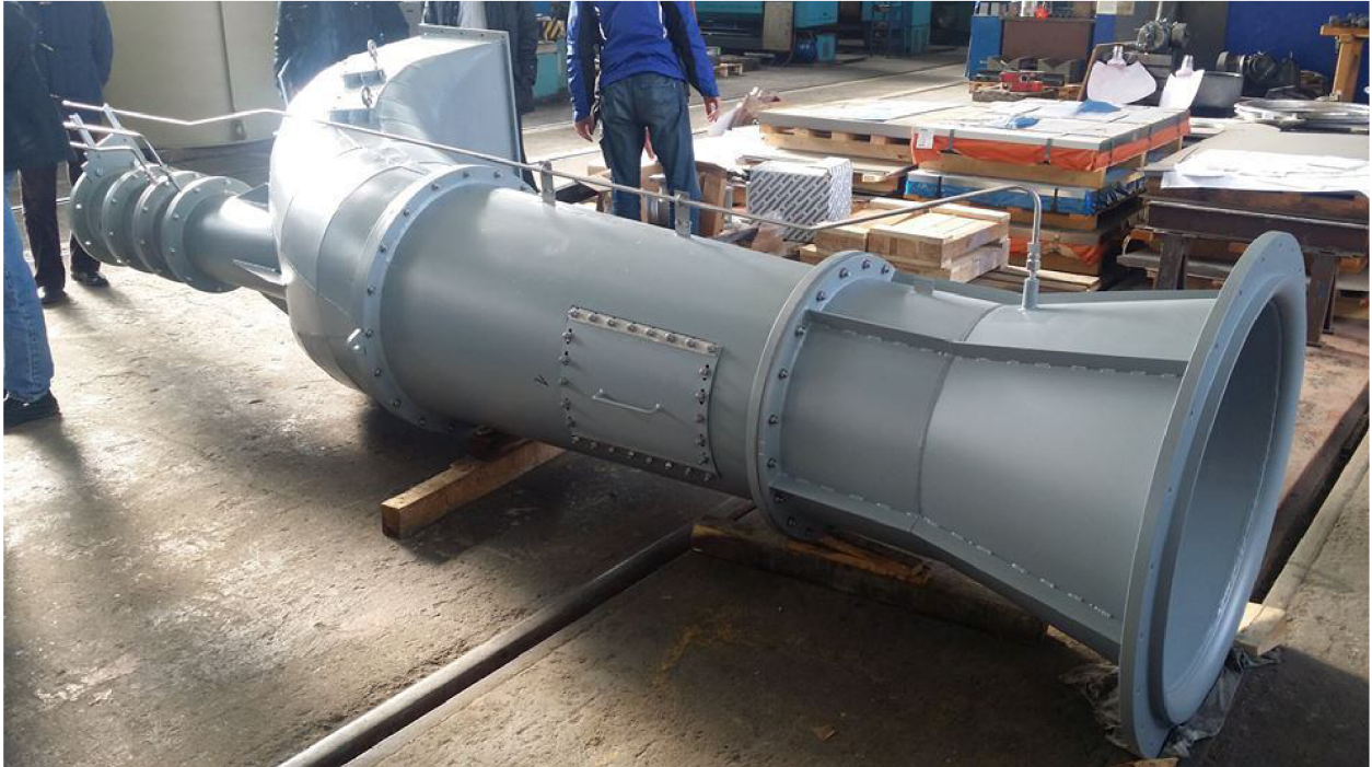
Obrázek 2.10: Část potrubí násoskové turbíny v Želině [23]
