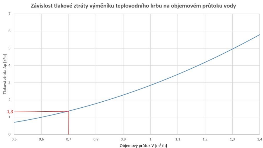
Obr. 25 Závislost tlakové ztráty výměníku teplovodního krbu na objemovém průtoku vody [10]
