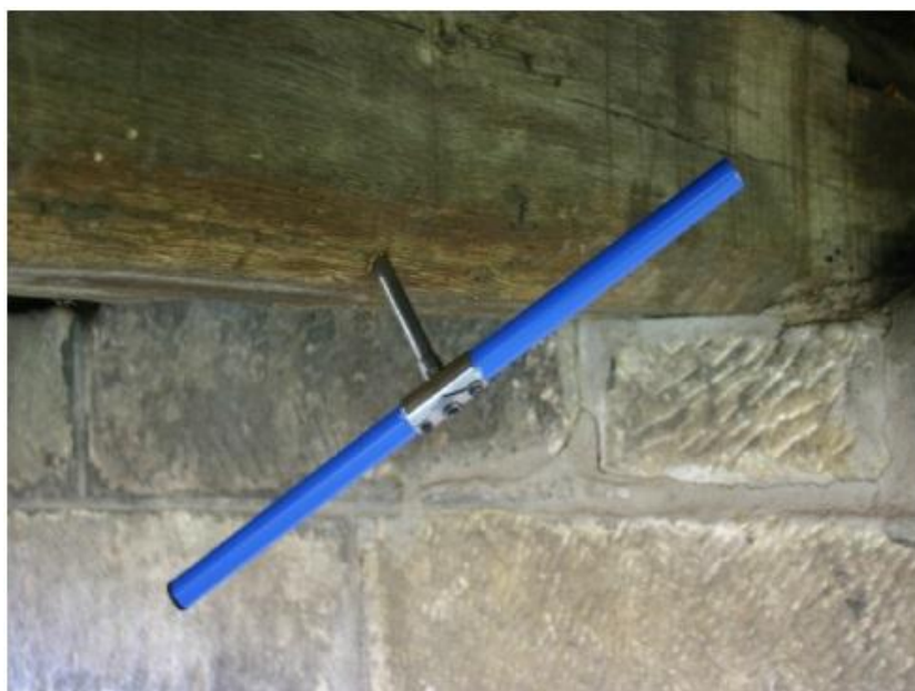
Obr. 10 Odber vzorku z historických konstrukcí pomocí Presslerova nebozezu (Rybniček, 2007)
