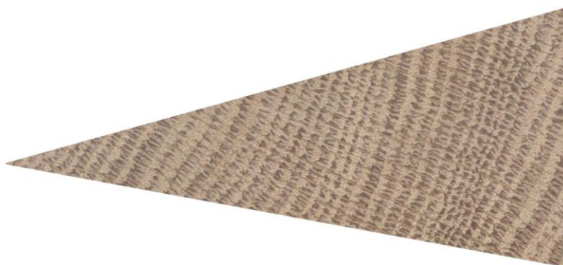
Obr. 18 příčný řez dubem ( http://ldf.mendelu.cz/und/sites/default/files/multimedia/stavba_dreva/lexikon/makro/index.html?drevina=db )
