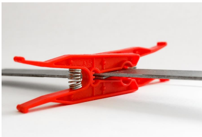
Obr. 14 Fixace lepeného spoje
