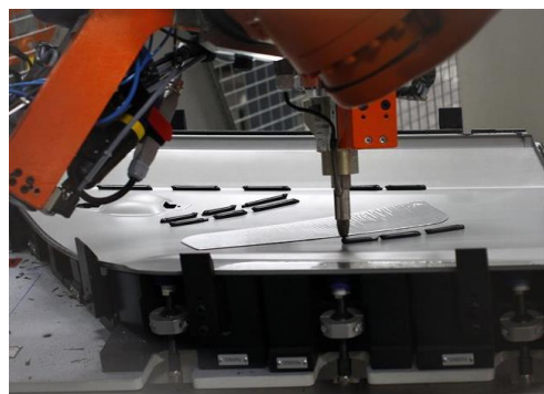
Obr. 1 Nanášení lepidla na díl dveří automobilu [37]
