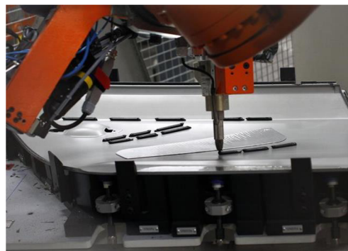
Obr. 1 Nanášení lepidla na díl dveří automobilu [37]
