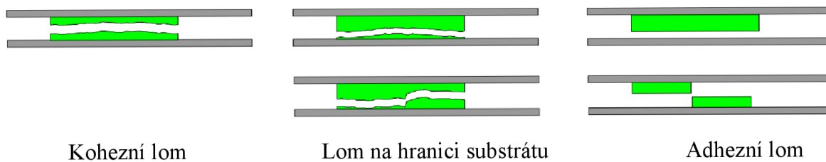
Obr. 12 Typy porušení lepeného spoje [39]
