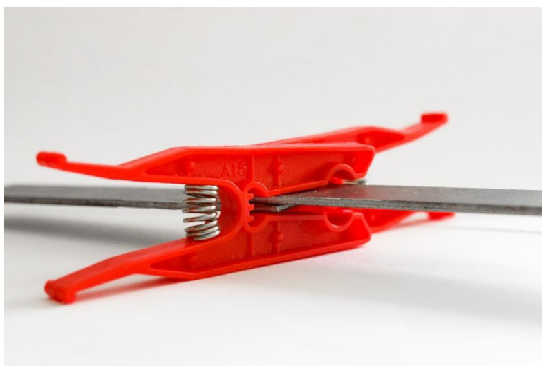
Obr. 14 Fixace lepeného spoje
