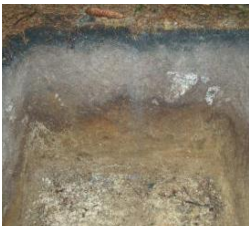
Obr. 9: Půdní profil podzolu na Lysině s výrazným vyběleným eluviálním horizontem, pod kterým leží tmavě zbarvený spodický horizont obohaceným o Al a Fe oxidy. (Převzato a upraveno podle www.czen.org )
