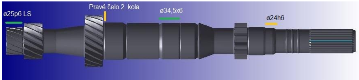
Obr. 4.3.1.2 Měřené plochy taktilní metodou – hnací hřídel [13]
