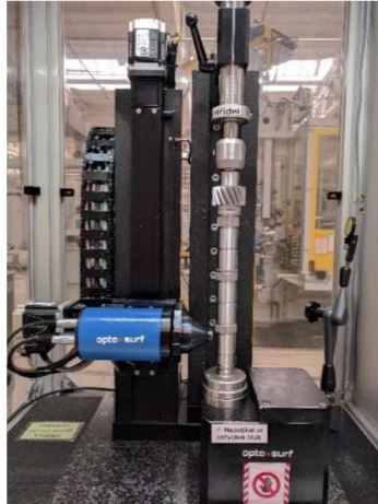
Obr 7.1 Měření textury povrchu a kruhovitosti senzorem OS500
