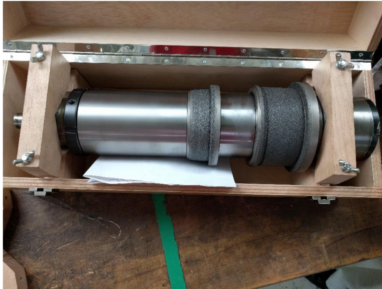
3.3 Orovnávací kotouč brusky GST – hnací hřídele
