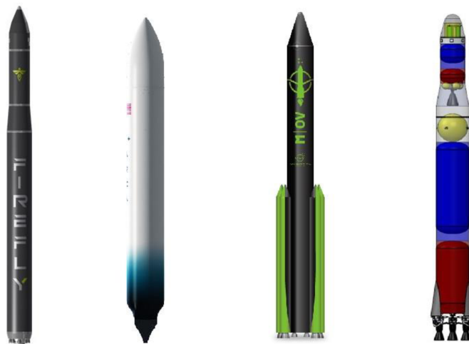
Obr. 5.1 Příklad lehkých nosičů s nosností do 500 kg, zleva doprava Firefly \alpha [33], Haas 2C [34], M-OV [35], NLV [36]
