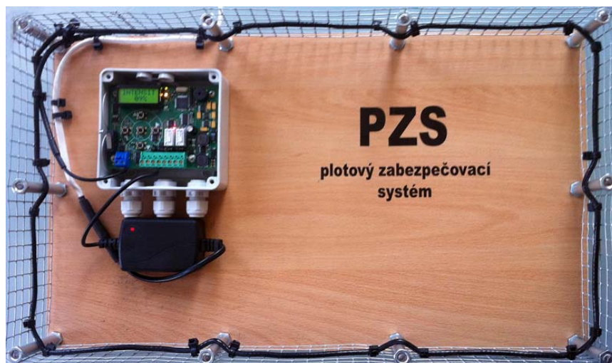
Obrázek 5.1: Model plotového zabezpečovacího systému (PZS)
