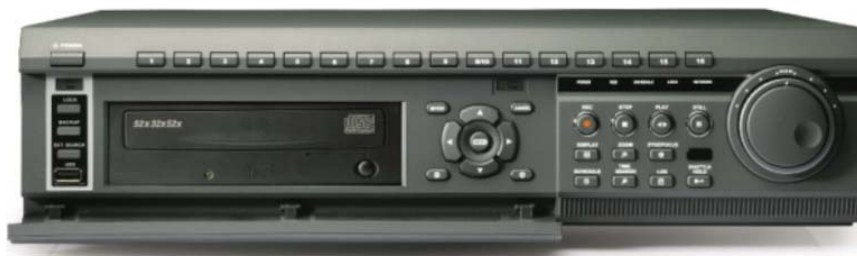
Obrázek 7.12: Digitální videorekordér PDR-X7016 (převzato z [24])
