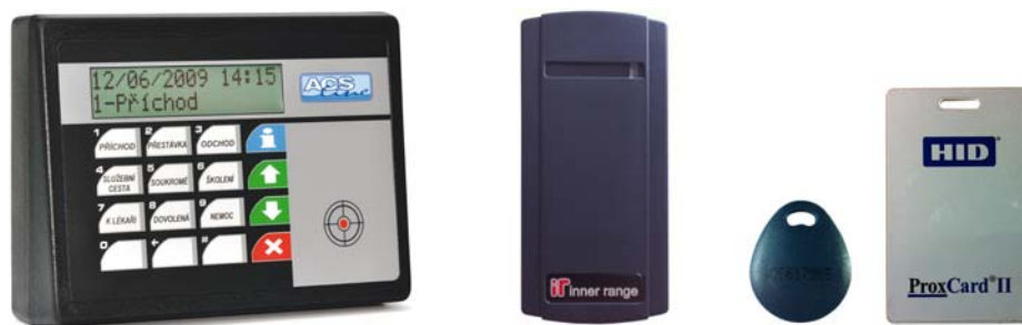
Obrázek 7.7: Navržený docházkový terminál, čtečka, přívěšek a karta
