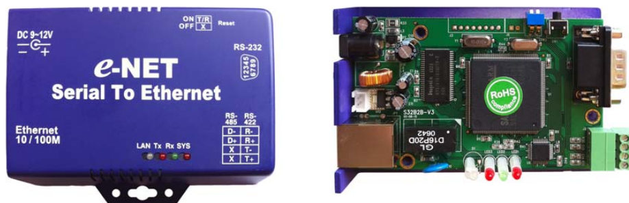
Obrázek 7.8: Pohled na odkrytovaný převodník e-NET E-P132-X
