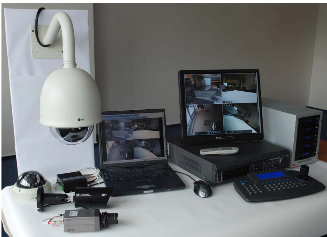
Obrázek D.5: Realizovaný kamerový (CCTV) systém
