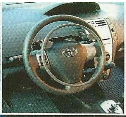
Obr. 2: Úprava motorového vozidla pro ruční řízení
