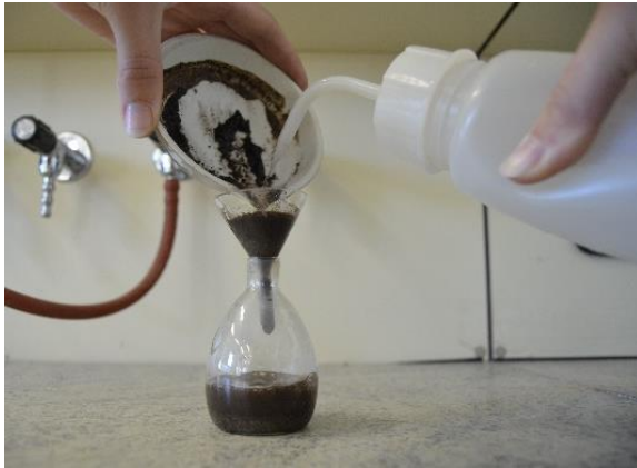
Obrázek 9: Vpravení vzorku do pyknometru
