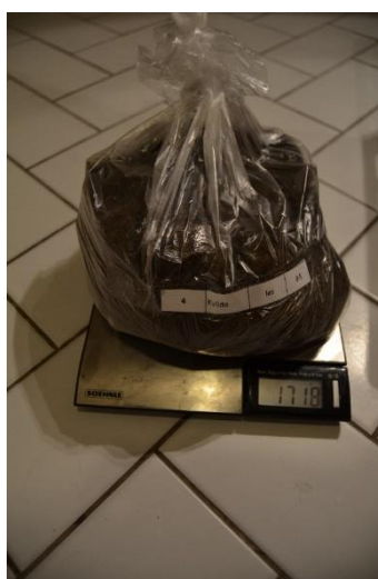
Obrázek 5: Vážení vzorku po odběru
