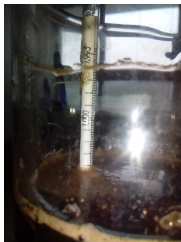
Obrázek 12: Odečítání z hustoměru
