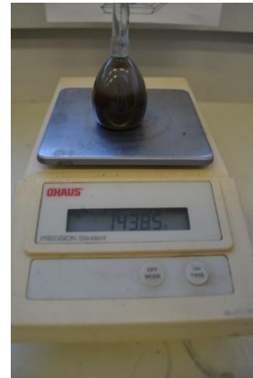
Obrázek 10: Opětovné vážení vzorku
