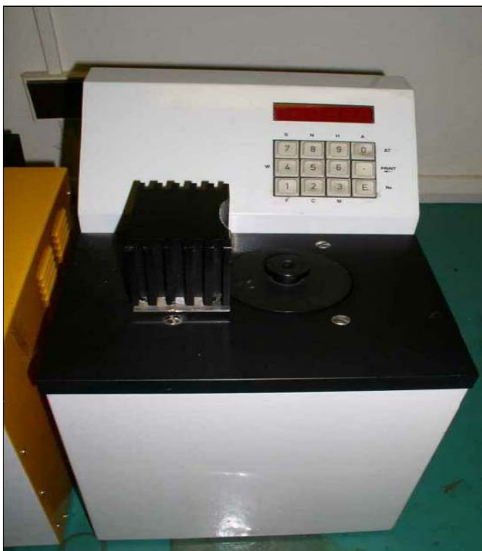
Obr. 1. Suchý adiabatický spalný kalorimetr LAGET MS 10 A (Hnilička, 2000)
