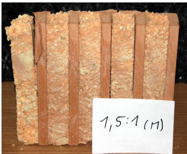
Obr. 59: Řez tvarovkou vyplněnou směsí 1,5:1 (M).
