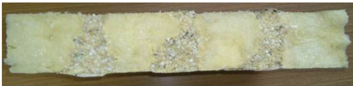
Obr. 47: Řez vzorkem plněným po vrstvách.
