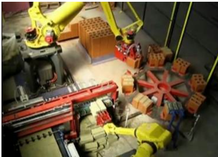
Obr. 10: Technologická linka pro vkládání kusového izolantu do keramických zděcích tvarovek, vertikální způsob vkládání na otočném stroji [13].
