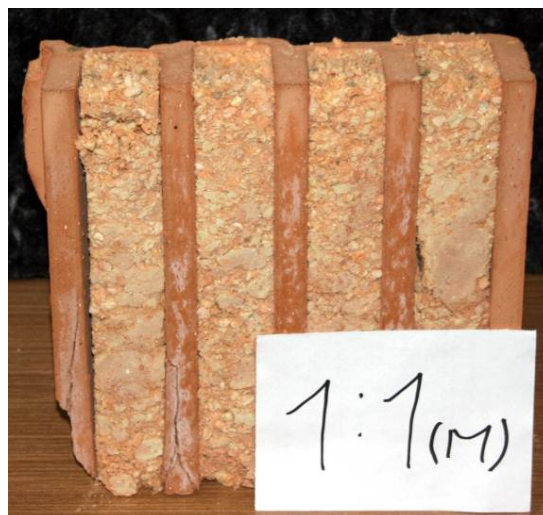
Obr. 60: Řez tvarovkou vyplněnou směsí 1:1 (M).
