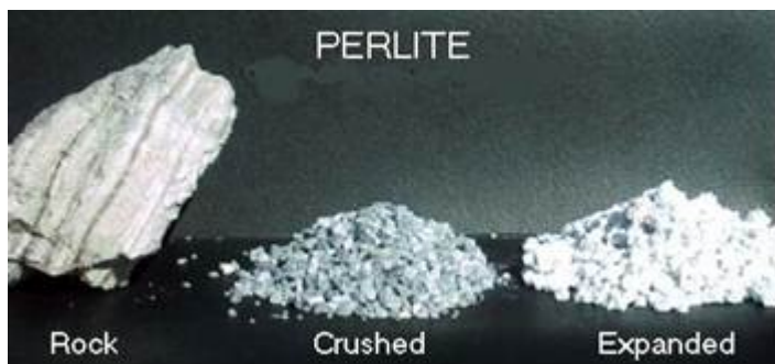
Obr. 24: Perlit ve formě horniny, granulátu a expandovaného perlitu [26].
