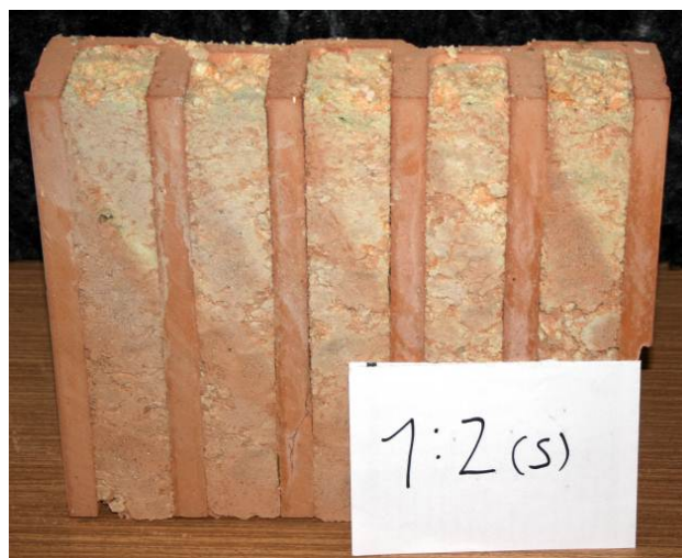
Obr. 58: Řez tvarovkou vyplněnou směsí 1:2 (S).
