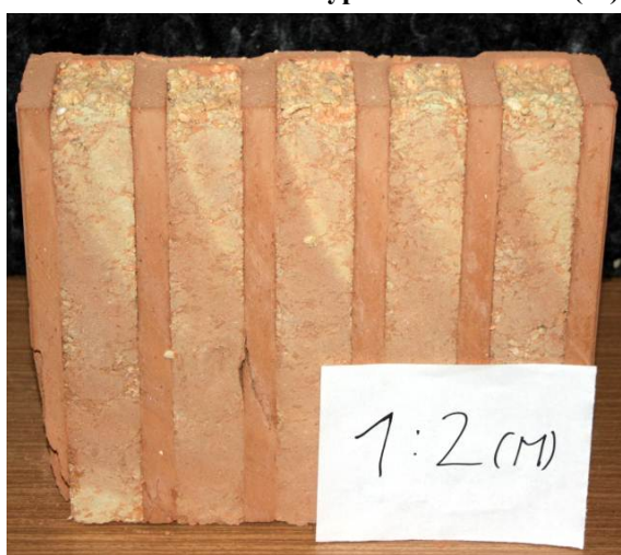
Obr. 62: Řez tvarovkou vyplněnou směsí 1:2 (M).
