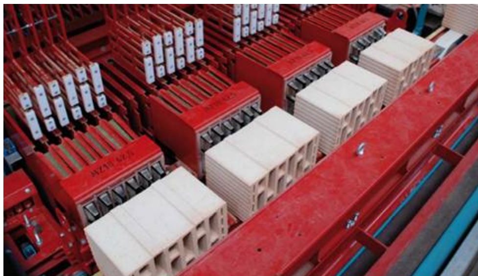
Obr. 9: Technologická linka pro vkládání kusového izolantu do keramických zděnic tvarovek, horizontální způsob vkládání [13].
