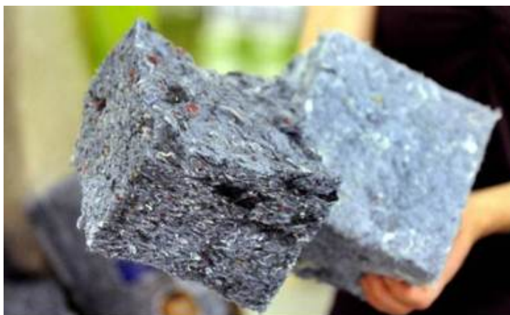
Obr. 33: Teplná izolace Ultra Touch vyrobená z recyklovaných triček a jeans [36].
