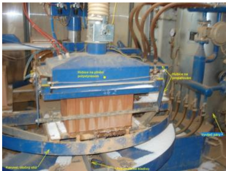
Obr. 12: Karusel pro plnění tvarovek polystyrenem [15].
