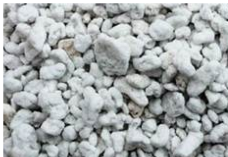
Obr. 25: Granulát perlitu vzniklý podrcením horniny [26].
