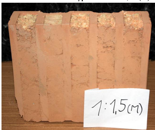
Obr. 61: Řez tvarovkou vyplněnou směsí 1:1,5 (M).
