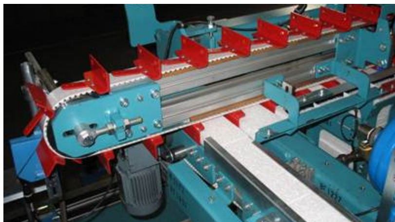
Obr. 7: Formování izolace z polystyrenu [13].
