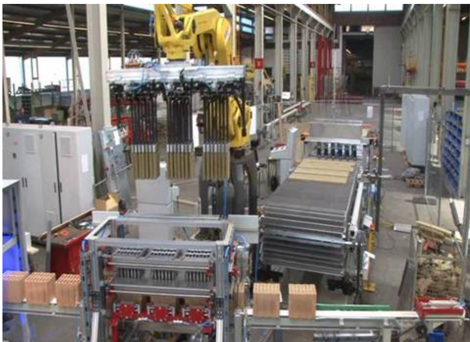
Obr. 11: Technologická linka pro vkládání kusového izolantu do keramických zděcích tvarovek, vertikální způsob vkládání [14].
