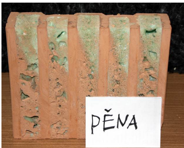
Obr. 57: Řez tvarovkou vyplněnou PUR pěnou.
