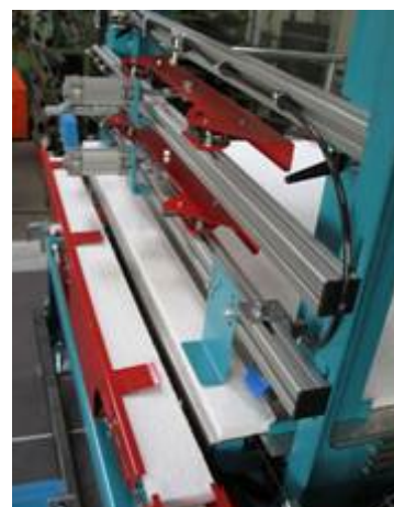
Obr. 8: Formování izolace z polystyrenu [13].
