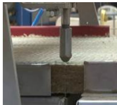
Obr. 6: Formování izolace z minerální vaty strunou [14].
