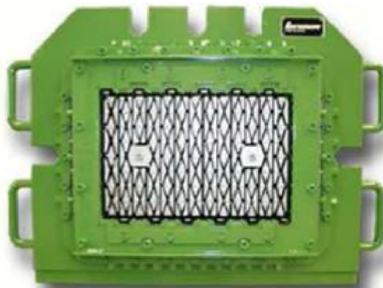
Obr. 4: Ústí vakuového šnekového lisu pro keramickou zdící tvarovku typu THERM [11].
