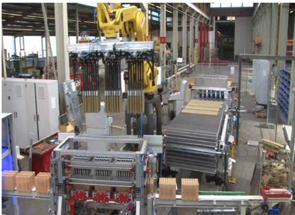
Obr. 11: Technologická linka pro vkládání kusového izolantu do keramických zdělic tvarovek, vertikální způsob vkládání [14].
