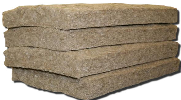
Obr. 36: Tepelná izolace ze lnu [40-A]
