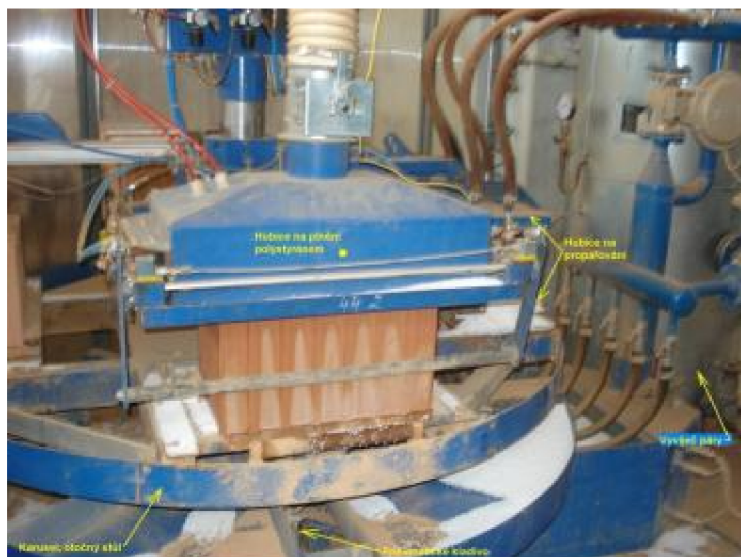
Obr. 12: Karusel pro plnění tvarovek polystyrenem [15].
