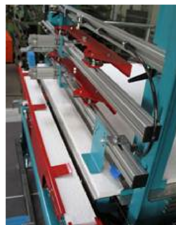
Obr. 8: Formování izolace z polystyrenu [13].
