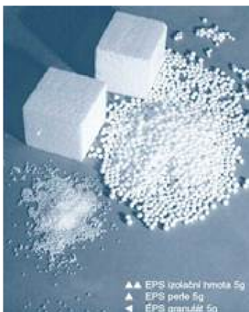
Obr. 14: EPS ve formě granulátu, perlí a izolační hmoty [19].
