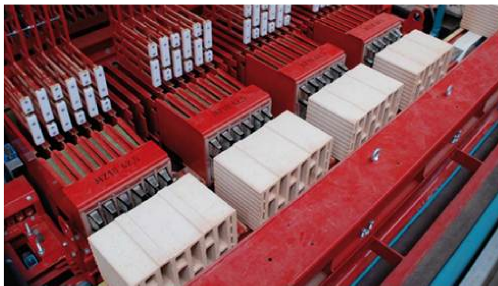
Obr. 9: Technologická linka pro vkládání kusového izolantu do keramických zděných tvarovek, horizontální způsob vkládání [13].
