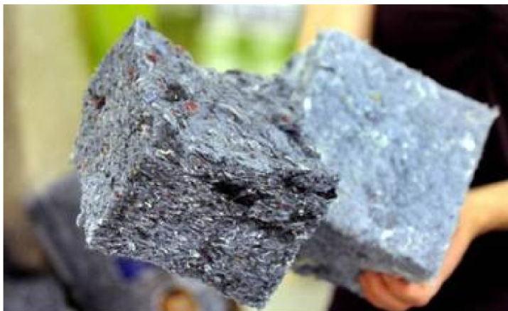
Obr. 33: Tepelná izolace Ultra Touch vyrobená z recyklovaných triček a jeans [36].
