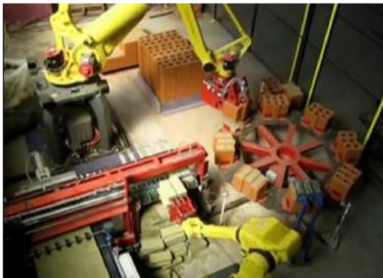
Obr. 10: Technologická linka pro vkládání kusového izolantu do keramických zdělic tvarovek, vertikální způsob vkládání na otočném stroji [13].
