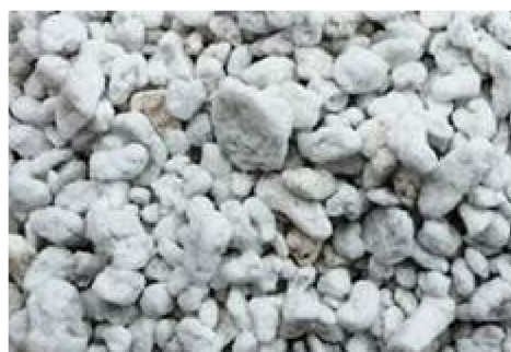
Obr. 25: Granulát perlitu vzniklý podrcením horniny [26].
