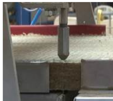
Obr. 6: Formování izolace z minerální vaty strunou [14].
