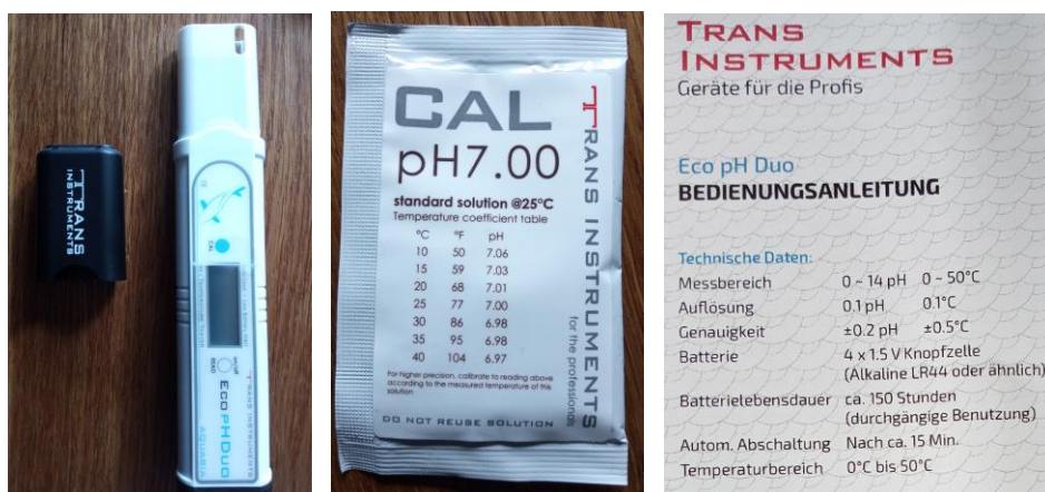
Obr. 38-40 přístroj na měření pH, Trans Instruments Eco pH Duo, vlevo přístroj, uprostřed kalibrační roztok, vpravo přesnost měření přístroje, zdroj: autor práce, 2024
