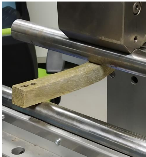
Obr. 51 třibodová zkouška ohybem kolmo na vlákna v tangenciálním směru, detail průhybu vzorku, zdroj: autor práce, 2022
