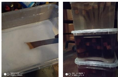
Obr. 35-36, kondicionace v nálevu roztoku močoviny a destilované vody v hmotnostním poměru 1:1, vlevo příprava roztoku, vpravo již vzorky v nálevu, zdroj: autor práce, 2021
