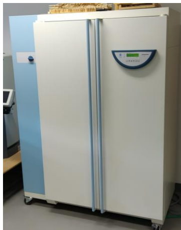
Obr. 41 klimatizační komora BMT MMM Group, zdroj: autor práce, 2022
