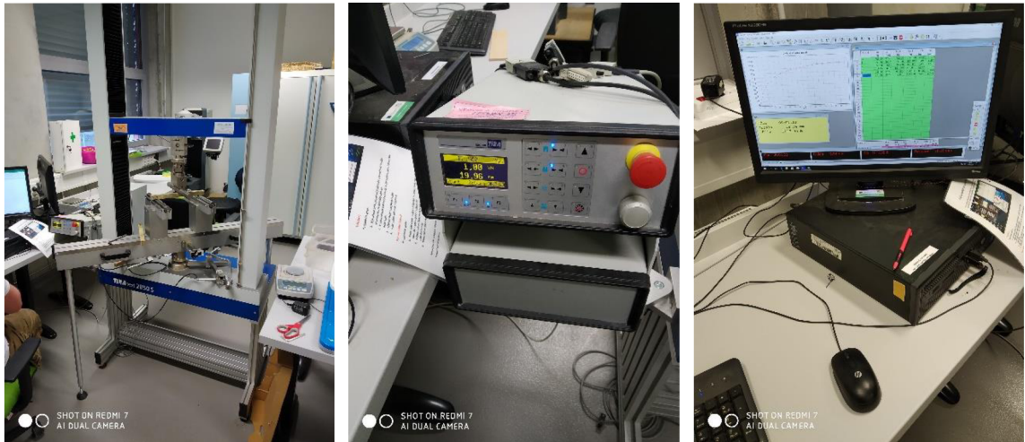
Obr. 42-44 zkušební zařízení pro mechanických zkoušení vzorků, vlevo zkušební stroj TIRA test 2850 S, uprostřed měřicí a snímací zařízení TIRA EDC 580, vpravo vyhodnocovací software TIRAtest TestCfg: TT2850 -TRS 2, zdroj: autor práce, 2022
