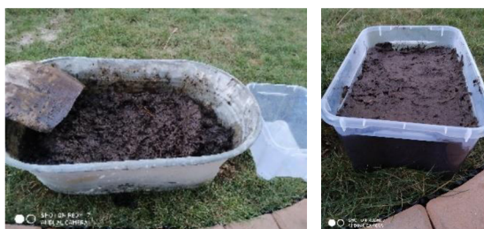
Obr. 33-34, kondicionace v nálevu z koňské mrvy, vlevo příprava směsi, vpravo vzorky v nálevu, zdroj: autor práce, 2021
