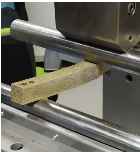
Obr. 51 tříbodová zkouška ohybem kolmo na vlákna v tangenciálním směru, detail průhybu vzorku, zdroj: autor práce, 2022
