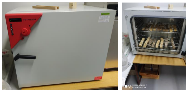
Obr. 45-46 sušení vzorků, vlevo klimatizační komora pro sušení vzorků BINDER JP 20, třída 2.0, vpravo vyjmutí vzorků, zdroj: autor práce, 2022
