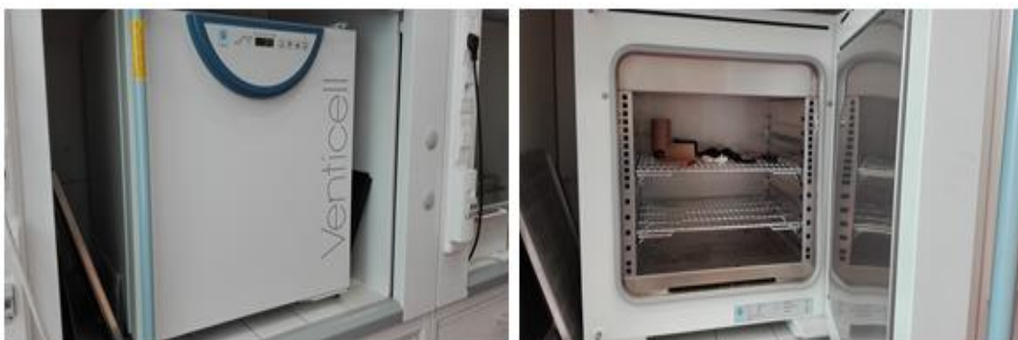
Obr. 12: Sušárna VENTICELL BMT
