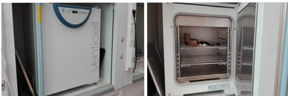
Obr. 12: Sušárna VENTICELL BMT
