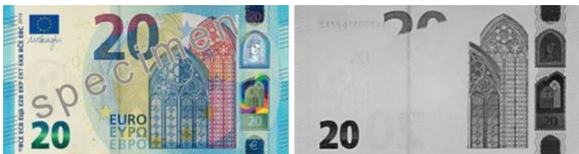
Obrázek 57 Ukázka použití metamerické barvy na eurobankovkovec
