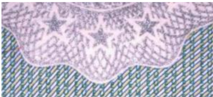
Obrázek 56 Tisk kovovou barvou – stříbřitě zbarvený kovový pigment 192
