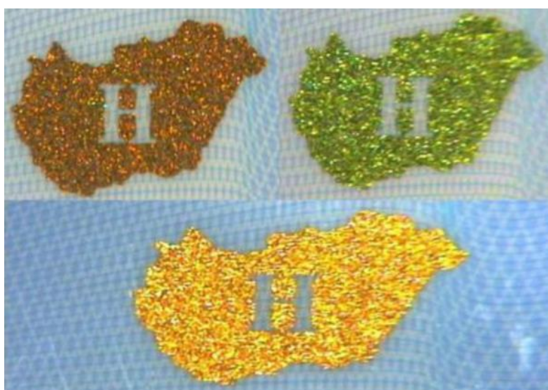
Obrázek 68 Příklad sítotisku opticky proměnlivou barvou 214
