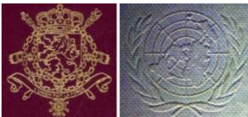
Obrázek 69 Ukázka ražby za tepla přes fólii (vlevo) a reliéfní ražby (vpravo) 216
