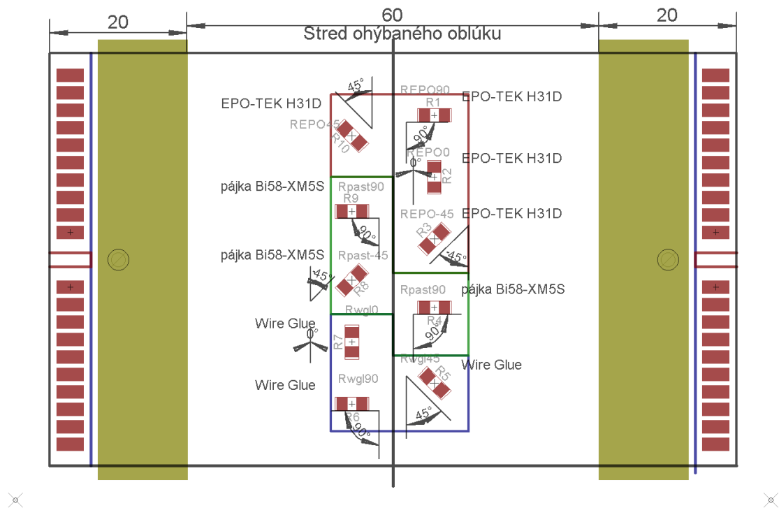
Obr. 4.3 Schéma rozloženia testovaných rezistorov podľa uhľa natočenia a rozloženia lepidiel
