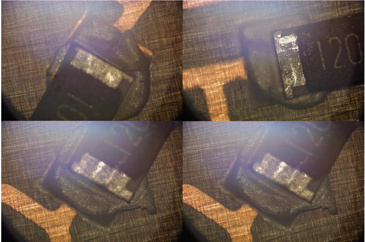
Obr. 4.4 Detail prilepených spojov vodivým lepidlom Epotek H31D po vytvrdení
