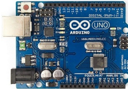
Obrázek 3.2: Vývojový kit mikrokontroléru Arduino Uno, převzato z [3]
