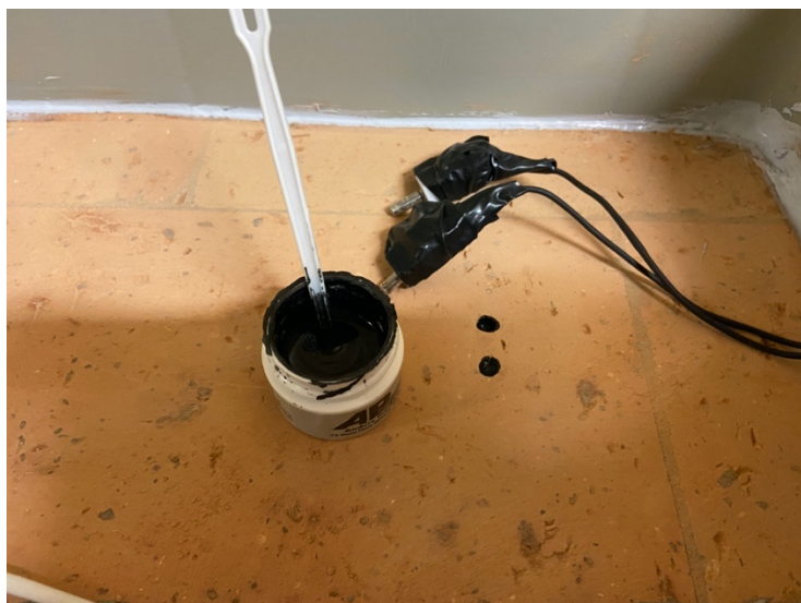
Obrázek 38: Ukázka aplikace elektrovedivého lepidla do předvrtaných otvorů před vložením odporových snímačů opatřených elektroizolační páskou
