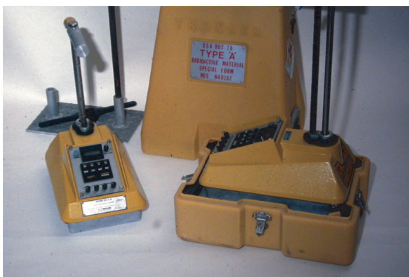
Obrázek 7: Fotografie radiometrické soupravy Troxler [14]
