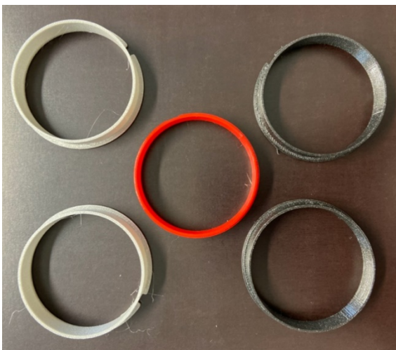
Obrázek 21: Ukázka vytvořených forem z 3D tiskárny pro výrobu vzorků pro měření kapacity
