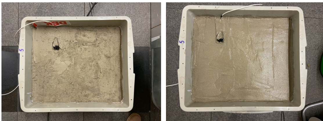
Obrázek 44: Fotografie z výroby experimentálního modelu s dvouvrstvou sanační omítkou
