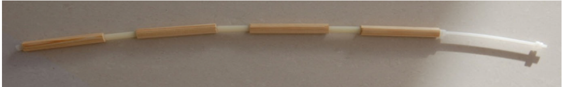
Obrázek 9: Fotografie tyče pro měření vlhkosti v různých hloubkách stěny [21]
