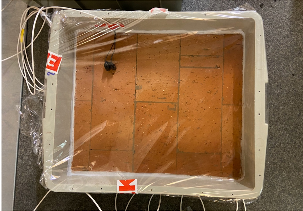
Obrázek 39: Fotografie zvlhčeného podkladního zdiva ošetřeného proti vysychání parotěsnou folií
