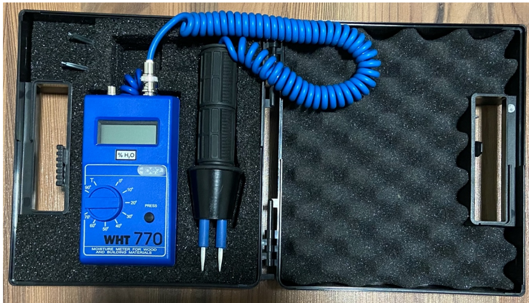
Obrázek 10: Fotografie odporového vlhkoměru ELBEZ WHT 770 s hrotovými sondami v transportním kufříku
