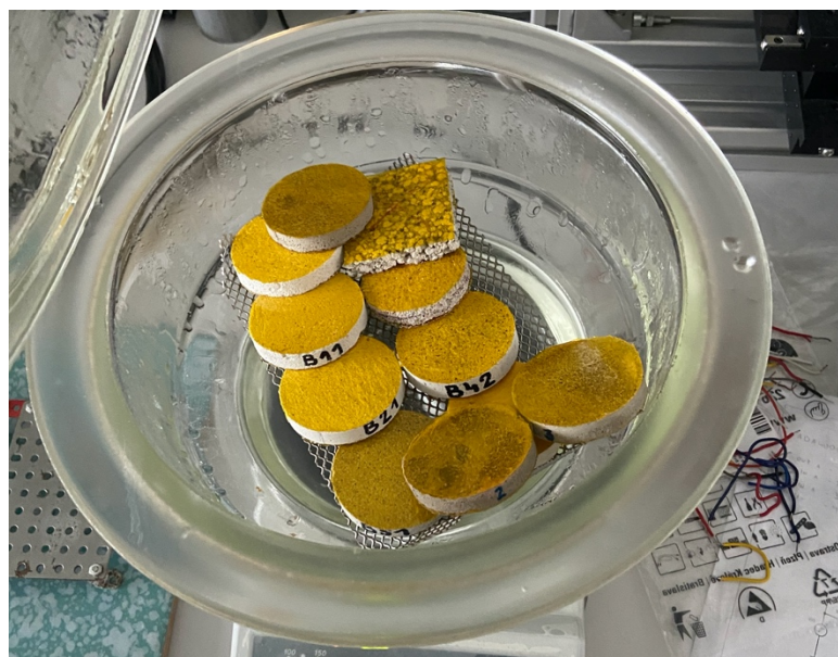
Obrázek 26: Fotografie vzorků opatřených kaptonovou páskou určených k vlhčení nad vodní hladinou v exsikátoru
