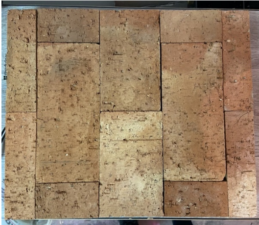
Obrázek 33: Fotografie zakrácených cihel připravených k vyždění podkladního zdiva
