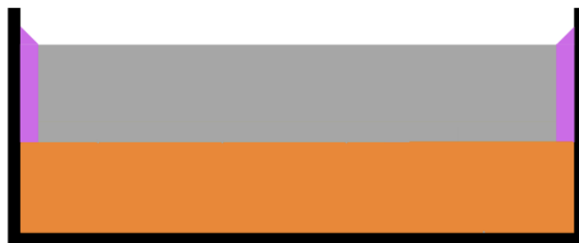
Obrázek 31: Schéma uspořádání experimentálního modelu vloženého do plastové nádoby (černě), s podkladním zdivem (oranžově), sanační povrchovou úpravou (šedě) a maltou pro utěsnění (fialově)
