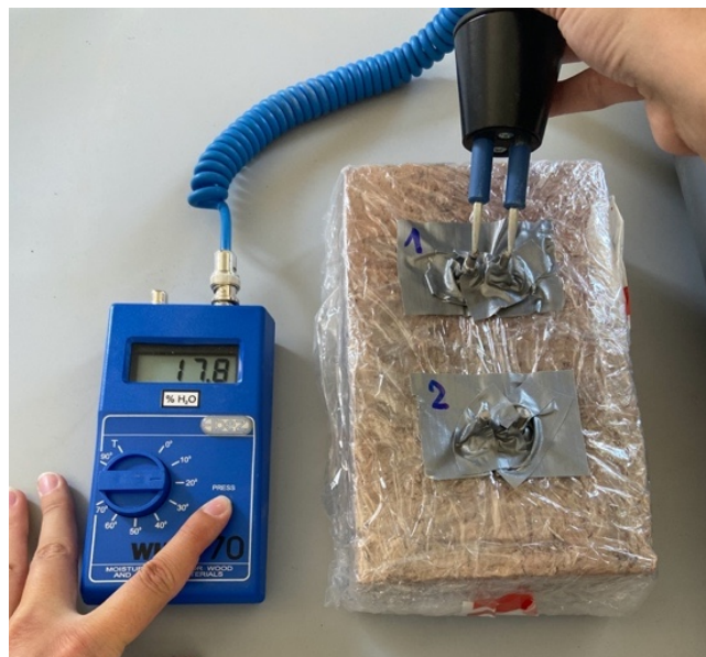
Obrázek 14: Fotografie měření vlhkosti CPP odporovým vlhkoměrem
