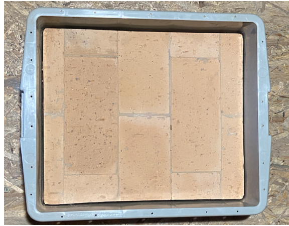
Obrázek 34: Fotografie vyžděného podkladního zdiva uloženého v plastové nádobě
