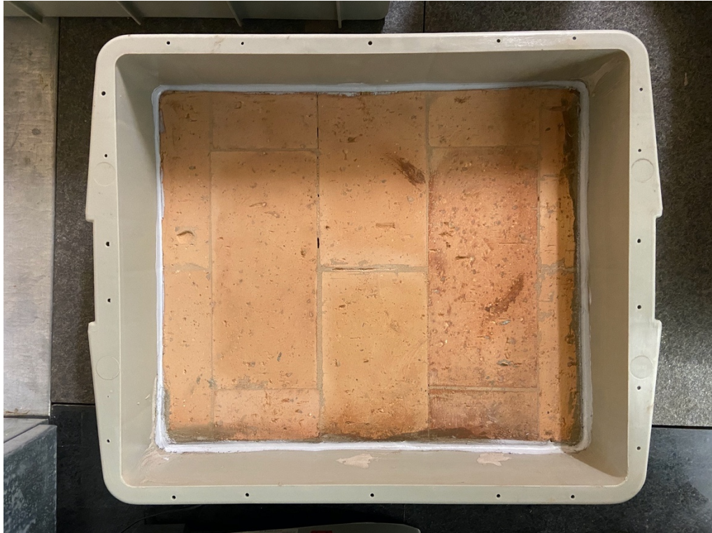
Obrázek 37: Vzhled zatmelené mezery (spáry) mezi zdivem a nádobou
