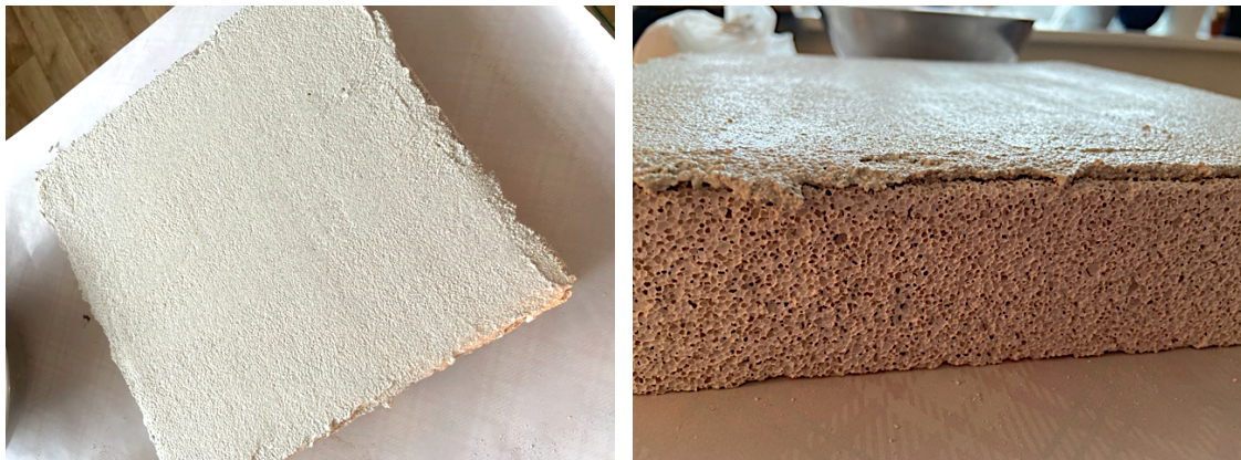
Obrázek 29: Fotografie vzorků pro kalibraci měření mikrovlnnou metodou
