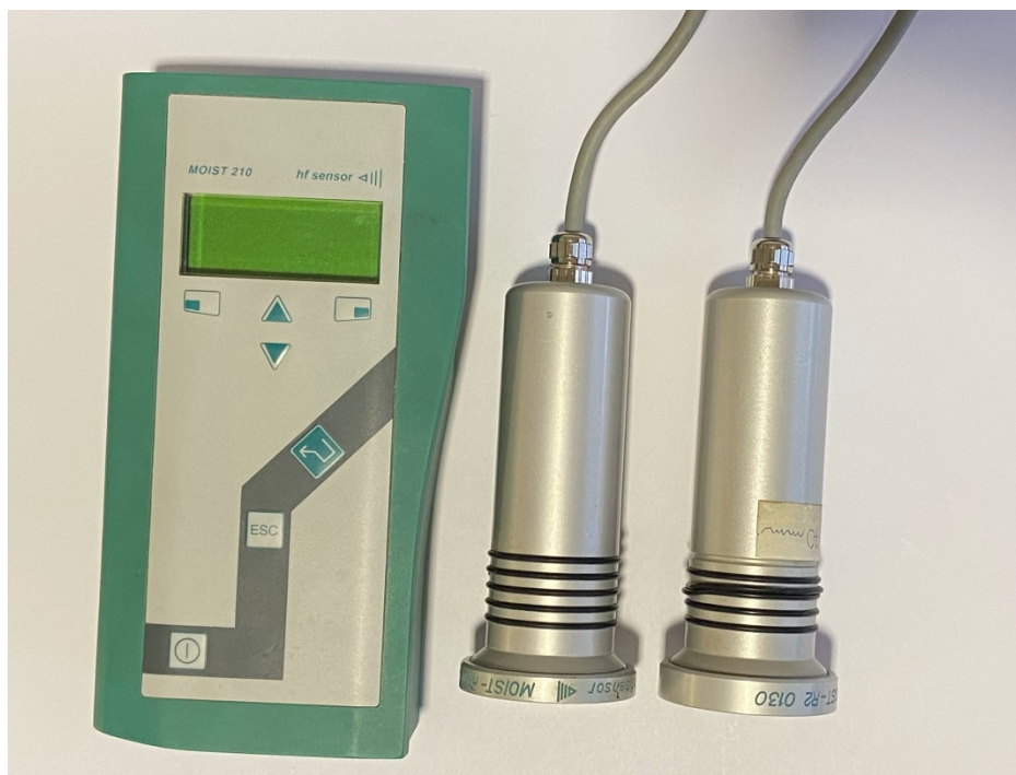
Obrázek 28: Fotografie zařízení MOIST 210 pro měření vlhkosti mikrovlnnou metodou s měřicími sondami
