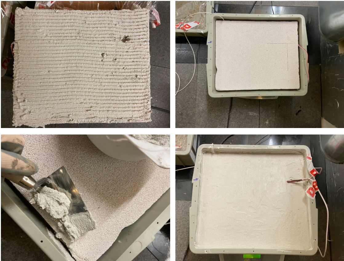
Obrázek 43: Fotografie z výroby experimentálního modelu s povrchovou úpravou z kalciumsilikátové desky a lehké minerální malty
