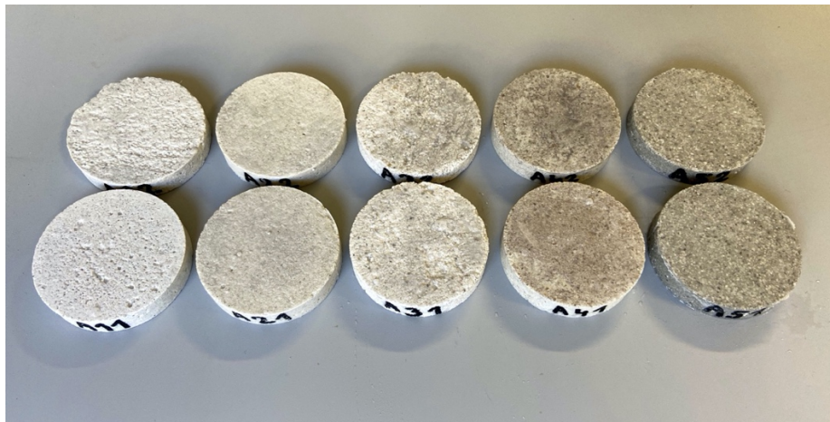
Obrázek 23: Vzhled vzorků pro měření kapacity po odformování a před broušením povrchu
