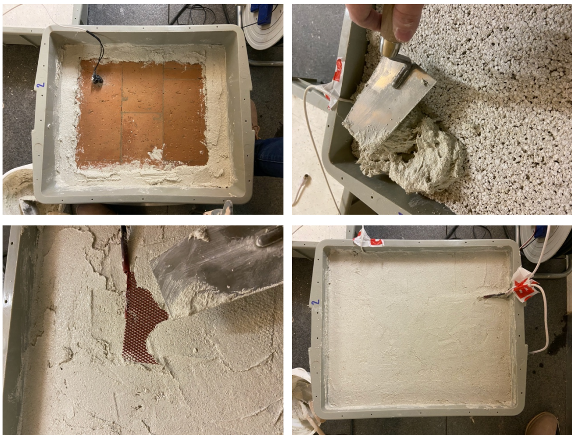
Obrázek 41: Fotografie z výroby experimentálního modelu s povrchovou úpravou z polystyrenbetonové desky a difuzně otevřeného lepidla
