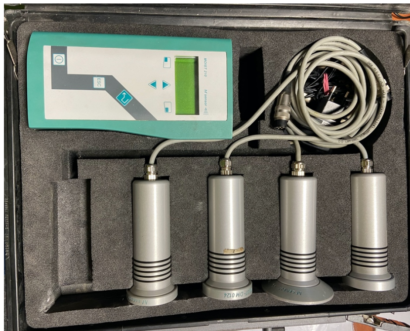
Obrázek 5: Fotografie mikrovlnného vlhkoměru Moist 210 s měřicími sondami do různých hloubek umístěné v transportním kufříku
