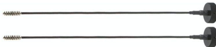
Obrázek 2: Fotografie kartáčkových sond pro odporový vlhkoměr [12]
