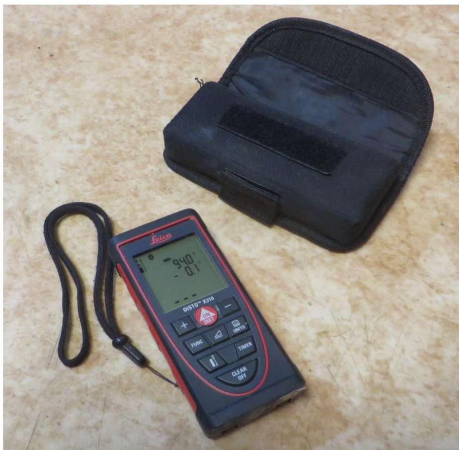
Obr. 4.1 - DistoX2 s obalem (Foto R. Kratochvíl)
