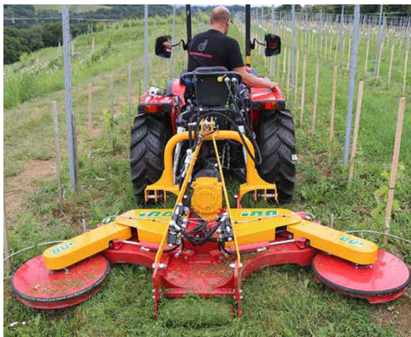
Obrázek 2: Sekačka Vinalia s výkyvnými rameny po obou stranách [2]
