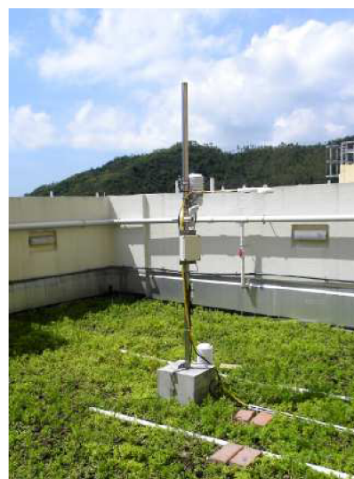
Obr. 33: Ukázka z měření teplot – zelená střecha s rozchodníkem mexickým [24]
