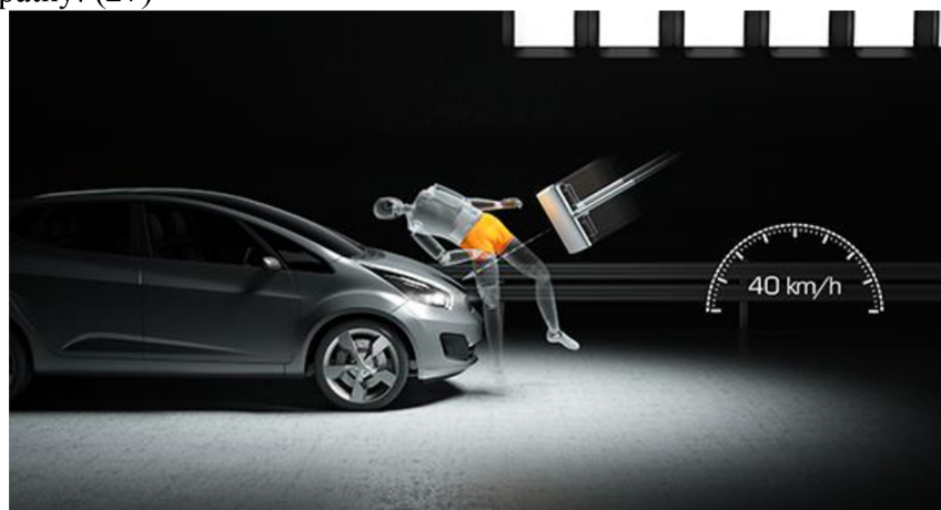
Obr 11 Zkouška střetu s pánví (27)
