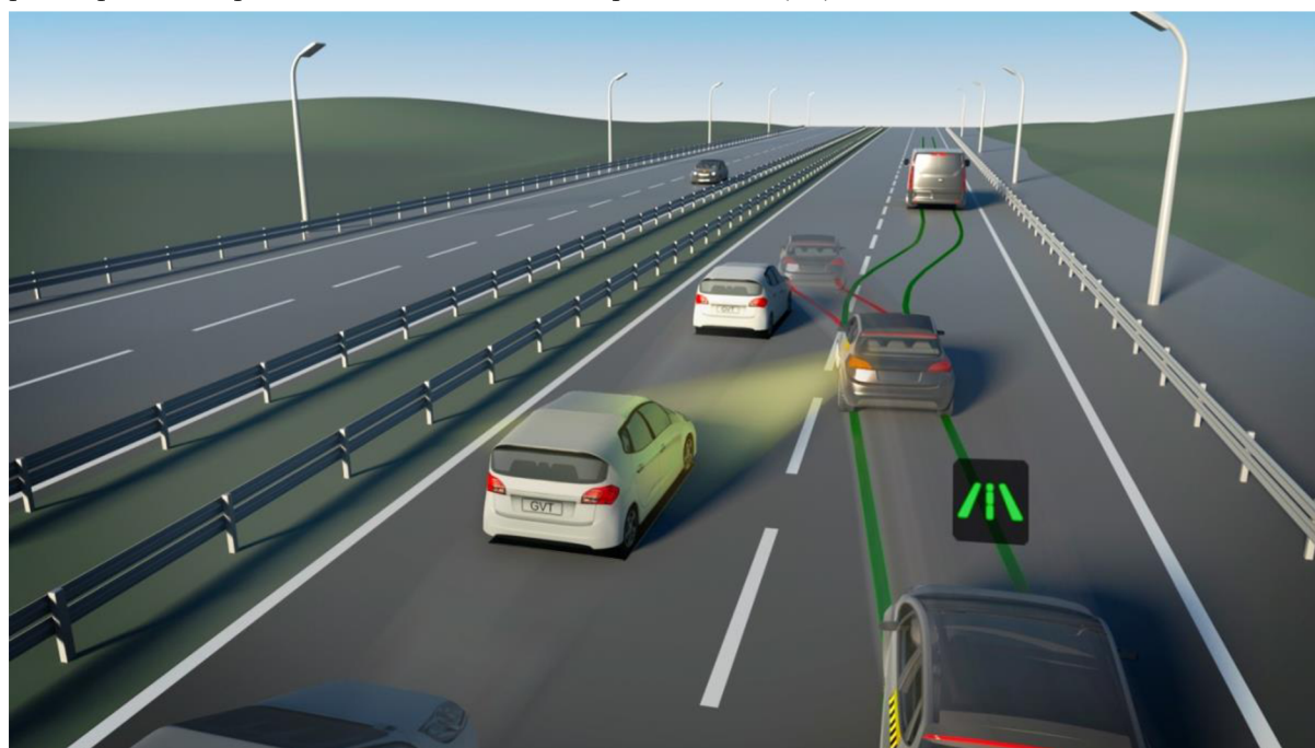
Obr 17 Schéma systému ELK při předjíždění
