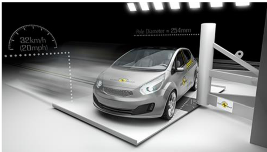
Obr 5 Grafické zobrazení zkoušky bočního nárazu do sloupu (20)
