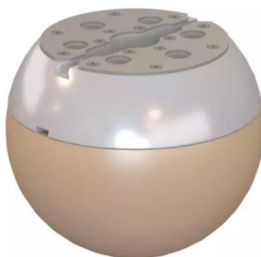
Obr 29 Hlavový Impaktor o váze 4,5kg
