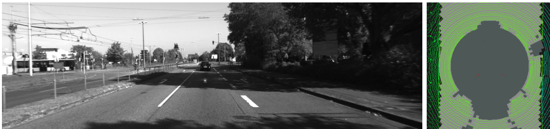
Obr. 7.14: Testovacia snímka 4. Obrázok naľavo ukazuje skúmanú scénu, kde sa vozidlo nachádza trojprúdovej ceste, ktorá je ohraničená vysokými obrubníkmi. Na obrázku v pravej je ortogonálny pohľad na mračno bodov tej istej scény.
