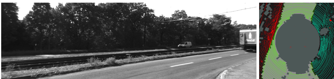
Obr. 7.14: Testovacia snímka 4. Obrázok naľavo ukazuje skúmanú scénu, kde sa vozidlo nachádza trojprúdovej ceste, ktorá je ohraničená vysokými obrubníkmi. Na obrázku v pravej je ortogonálny pohľad na mračno bodov tej istej scény.
