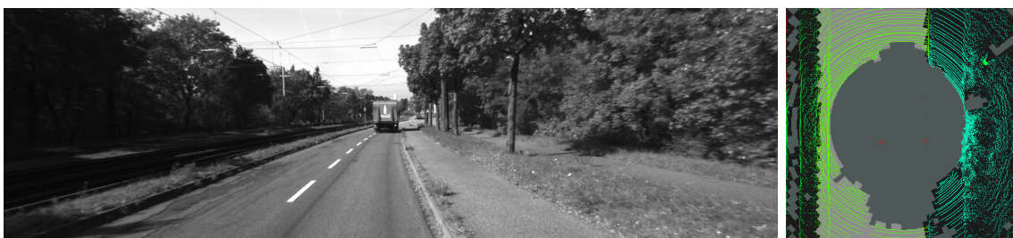
Obr. 7.16: Testovacia snímka 6. Scéna na ľavom obrázku ukazuje rovnú cestu po oboch stranách ohraničenú výraznými obrubníkmi. Obrázok vpravo ukazuje tú istú scénu, ale ako ortogonálny pohľad na mračno bodov. Na tejto snímke je vidieť chybnú anotáciu ľavého obrubníka.
