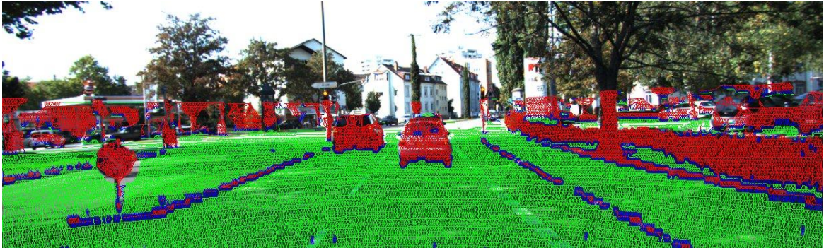
Obr. 2.1: Výsledok detekcie prekážok. Zelené body reprezentujú tie prechody kde nie sú prekážky, modré body prechod medzi prekážkou a cestou, červené body prechod v prekážke.
