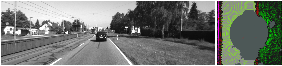
Obr. 7.11: Testovacia snímka 1. Obrázok naľavo ukazuje scénu, na ktorej sa nachádza výrazne ohraničená dvojprúdová cesta. Obrázok vpravo ukazuje tú istú scénu, ale ako ortogonálny pohľad na mračno bodov.
