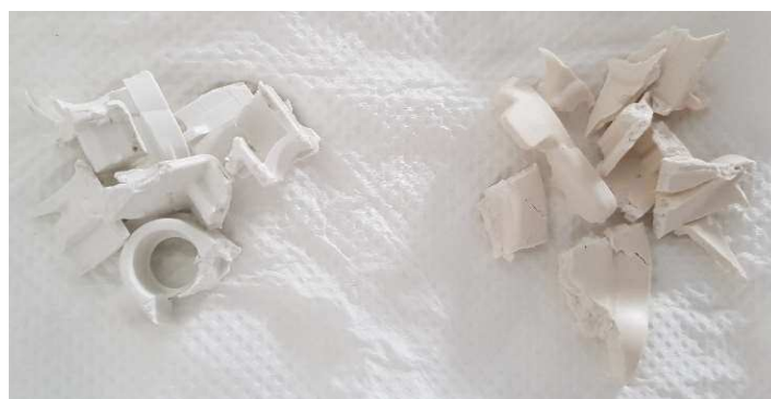
Obr. 59 Oddělené vzorky pro zkoušku hustoty: a) materiál A; b) materiál B.
