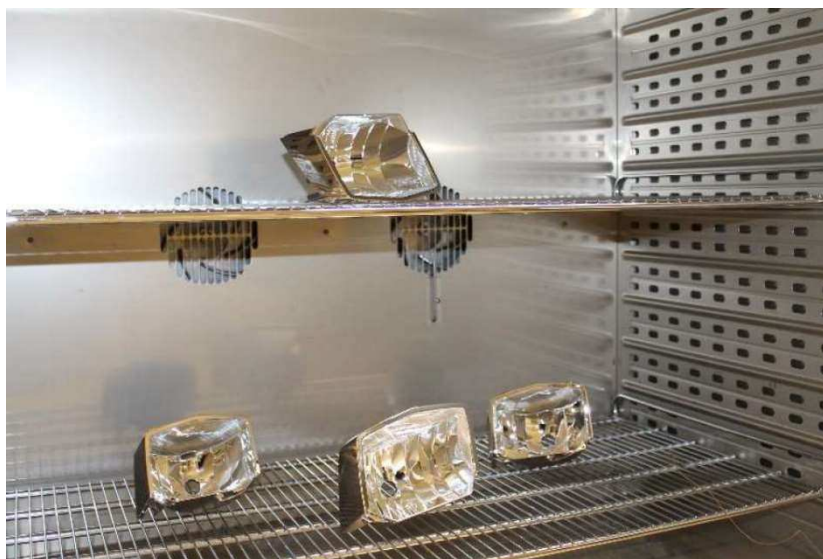
Obr. 73 Uložení reflektorů v teplotní komoře.
