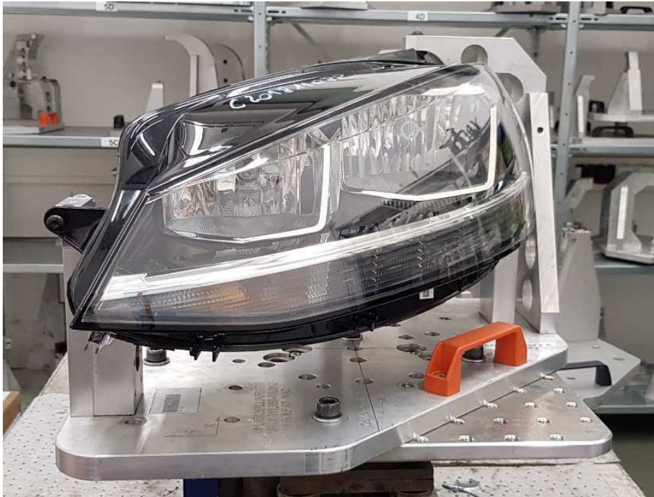
Obr. 77 Uchycení reflektoru v přípravku pro testování vibrací.
