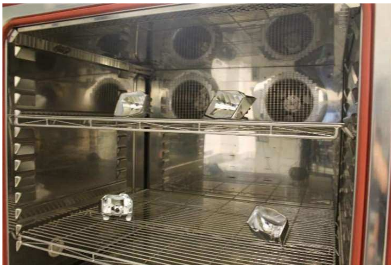
Obr. 71 Klimatická komora s testovanými reflektory.
