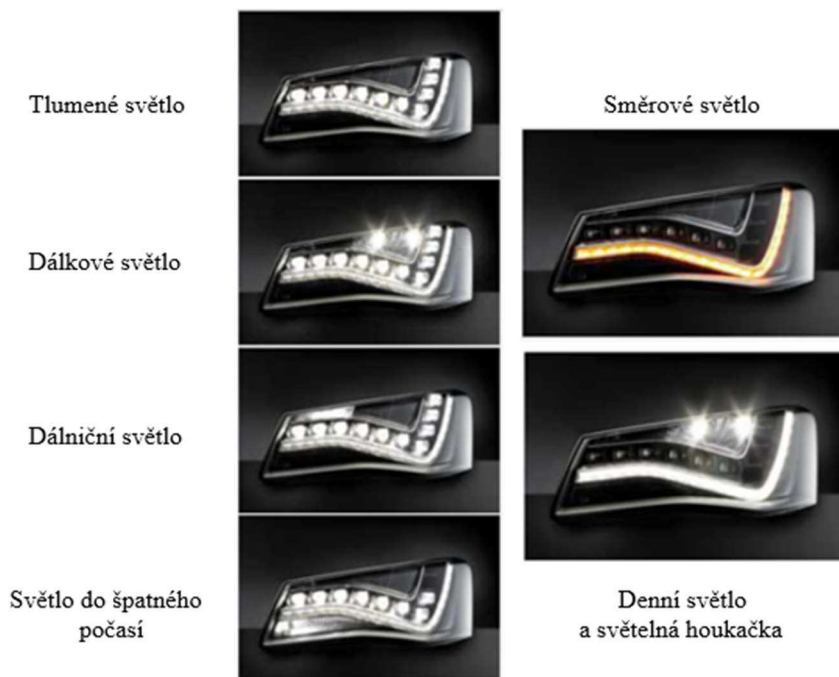
Obr. 2 Aplikace režimů svícení ve světlometu Audi A8 – podle [7].
