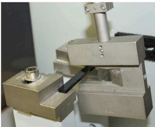
Obr. 28 Průběh rázové zkoušky metodou Charpy [28].
