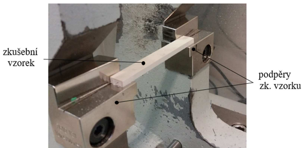
Obr. 54 Uložení zkušebního tělesa na podpěrách při rázové zkoušce metodou Charpy.
