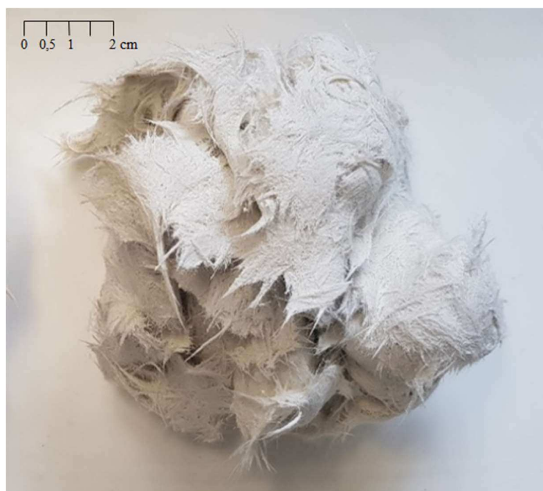
Obr. 18 Termosetová kompozitní směs BMC.
