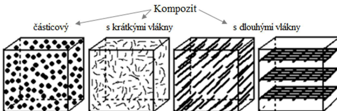
Obr. 17 Rozložení kompozitních materiálů dle geometrického tvaru výztuže – podle [22].
