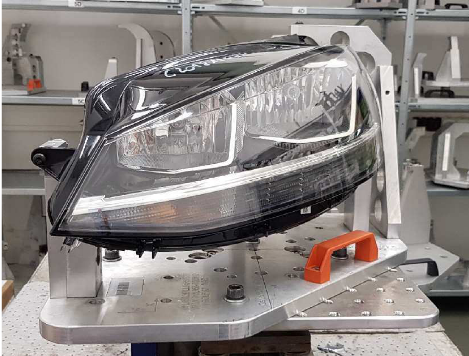
Obr. 77 Uchycení reflektoru v přípravku pro testování vibrací.
