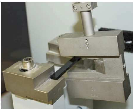
Obr. 28 Průběh rázové zkoušky metodou Charpy [28].
