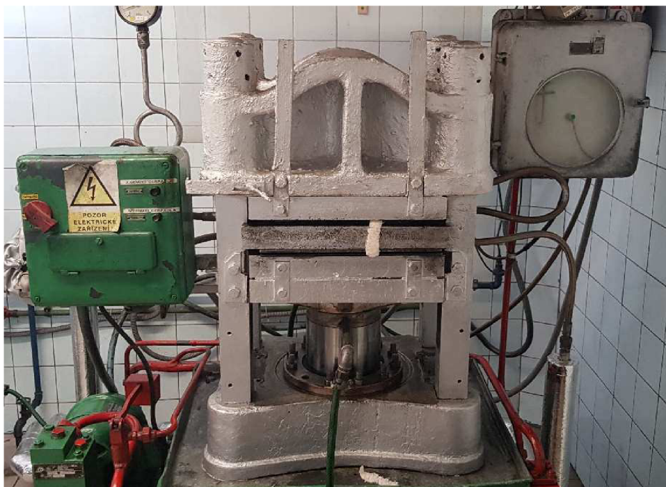
Obr. 37 Průmyslový lis pro přípravu destiček.
