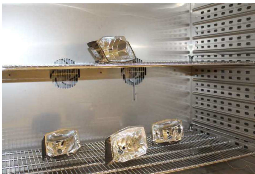
Obr. 73 Uložení reflektorů v teplotní komoře.
