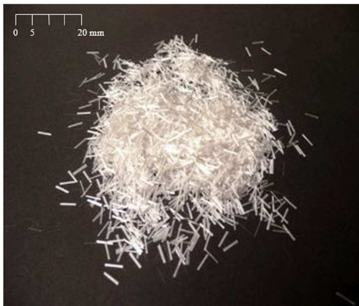
Obr. 19 Sekaná skleněná vlákna – podle [38].
