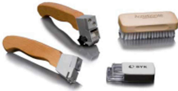
Obr. 62 Ruční řezací nástroj s břitem pro vytvoření mřížky [7].
