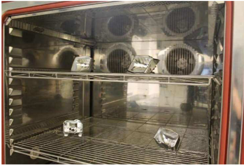
Obr. 71 Klimatická komora s testovanými reflektory.
