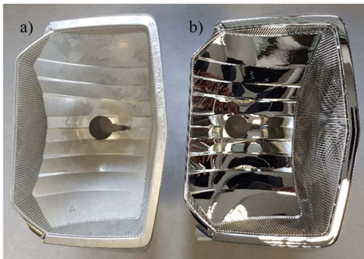
Obr. 78 Srovnání pokovení: a) přímé (bez laku); b) standartní s předchozí operací lakování.
