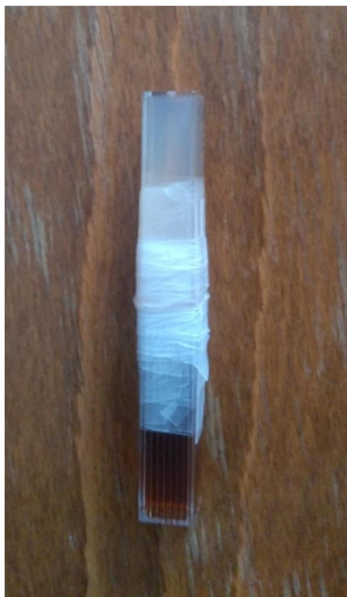
Obr. 10: připravený difúzní pár
