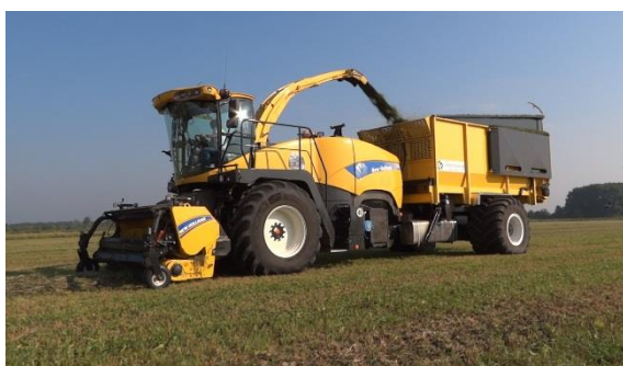
Obrázek 38 – Speciálně upravená sklízecí řezačka s překládací nástavbou (Zdroj: www.youtube.com )
