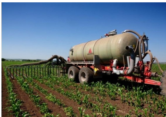
Obrázek 22 - Sklolaminátová cisternová nástavba s hadicovým aplikátorem (Zdroj: www.crs-marketing.cz )
