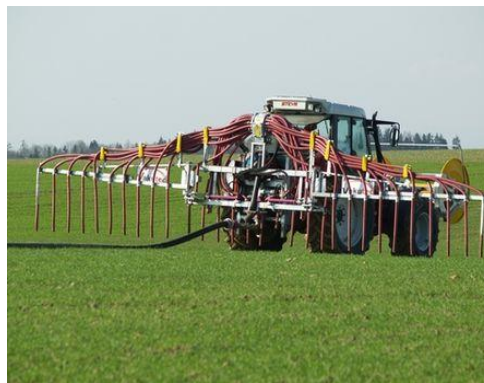
Obrázek 35 - Systém hnojení pomocí vlečných hadic Vakutec Turbo (Zdroj: www.vakutec.at.)
