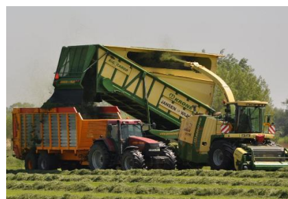
Obrázek 39 - Samojízdná sklízecí řezačka doplněná speciálním podvozkem a polohovatelnou překládací nástavbou (Zdroj: www.trekkerweb.nl )
