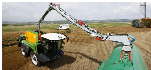
Obrázek 36 - Rychlé plnění postřikovače ramenem cisterny pro zvýšení výkonnosti aplikace (Zdroj: www.zavesnatechnika.cz )
