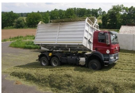
Obrázek 3 – Nosič výměnných nástaveb v agregaci s velkoobjemovou nástavbou (Foto: Milan Hrach)
