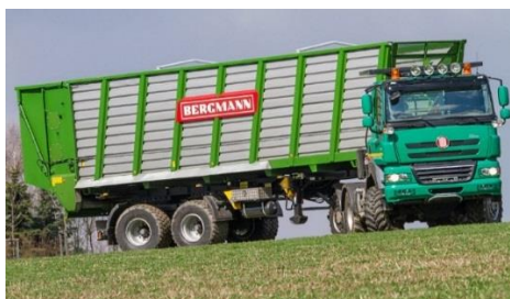
Obrázek 10 - Podvozek Umikov s výměnnou nástavbou Bergman (Zdroj: www.pal.cz)
