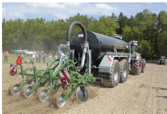
Obrázek 23 – Ocelová cisternová nástavba s radličkovým aplikátorem (Zdroj: www.unimarco.cz )
