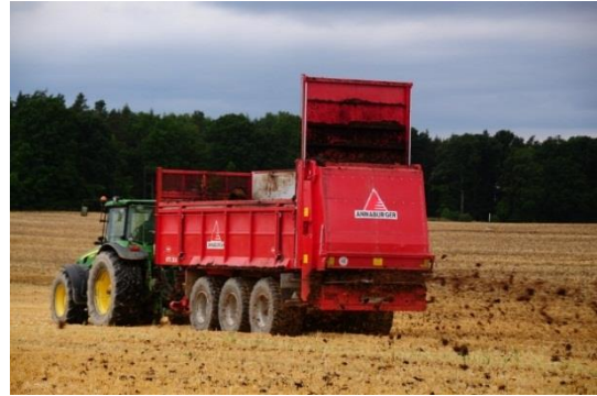
Obrázek 25 - Návěs Teleliner s výškově nastavitelnými bočnicemi (Zdroj: www.crs-marketing.cz )
