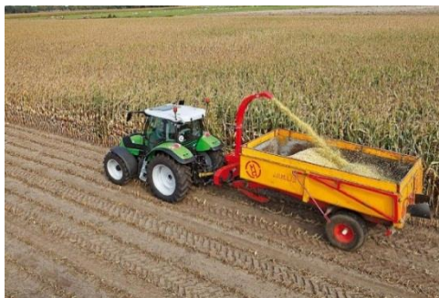
Obrázek 37 – Využití dělené dopravy při sklizni silážní kukuřice (Zdroj: www.manzt.cz )
