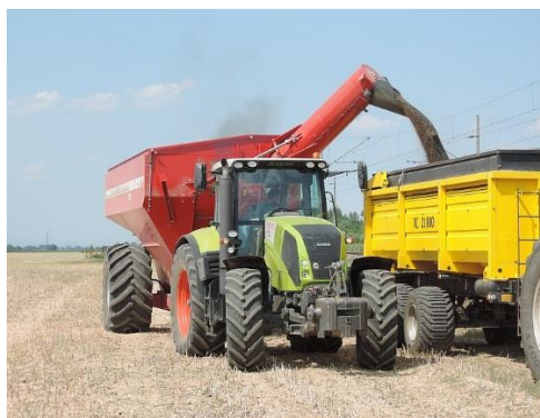
Obrázek 20 - Překládací návěs při překládce do odvozního prostředku (Zdroj: www.horsch2.com )
