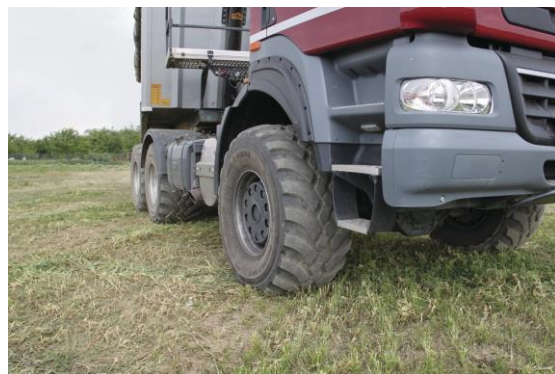
Obrázek 2 – Flotační pneumatika se šípovým dezénem (Zdroj: www.stavebni-technika.cz )
