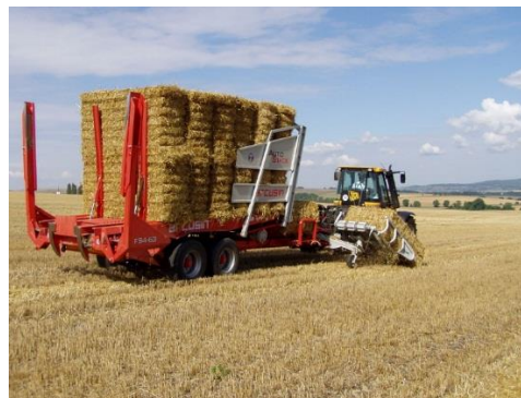
Obrázek 27 - Návěs pro přepravu hranolových balíků (Zdroj: www.toko.cz )
