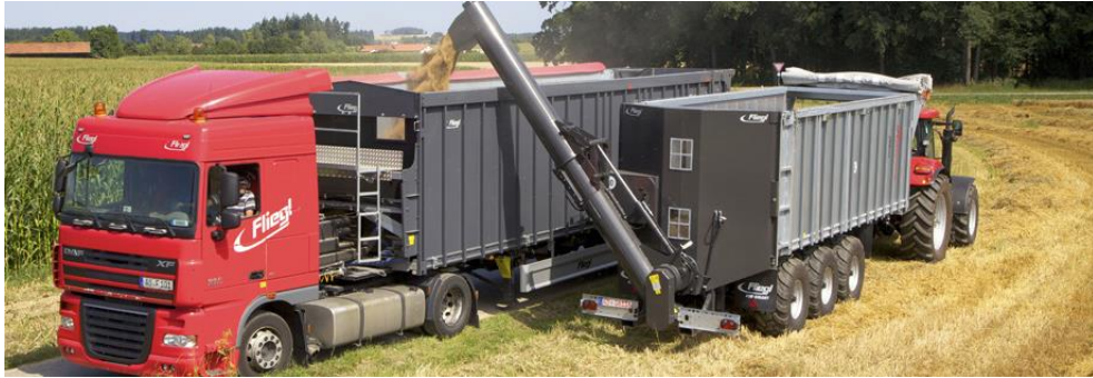
Obrázek 30 – Vyrnovací návěs opatřený překládacím čelem pro plnění odvozních souprav (Zdroj: www.flietl-agrartechnik.de )
