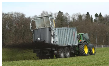
Obrázek 19 - Vyrhovací nástavba agregovaná s rozmetadlem statkových hnojiv (Zdroj: www.fliegl-agrartechnik.de )
