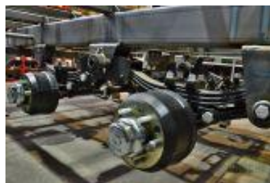
Obrázek 17 - Detail parabolického odpružení (Zdroj: www.danhel.cz )
