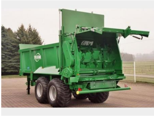
Obrázek 24 - Rozmetadlo hnoje s horizontálními frézovacími válci (Zdroj: www.pekass.cz )
