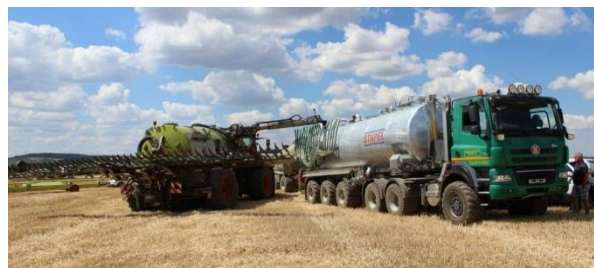
Obrázek 32 - Přečerpávání hnojiva do aplikátoru na souvrati (Zdroj: www.mechanizaceweb.cz)
