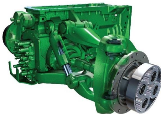
Obrázek 13 - Nezávislé odpružení přední nápravy u traktorů John Deere řady 8000 (Zdroj: www.danhel.cz )
