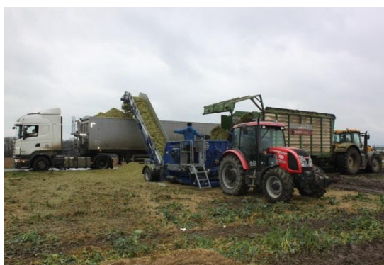
Obrázek 41 - Oddělení polní a silniční dopravy za pomoci překládací stanice (Zdroj: www.mechanizaceweb.cz )
