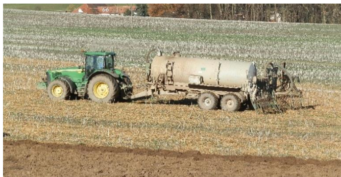
Obrázek 44 - Souprava traktoru John Deere 8320 a návěsu Fliegl s kejdovací cisternou a hadicovým aplikátorem při aplikaci kejdy (Foto: Milan Hrach)
