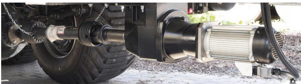
Obrázek 28 - Pohon nápravy elektromotorem (Zdroj: www.fliegl-agrartechnik.de )
