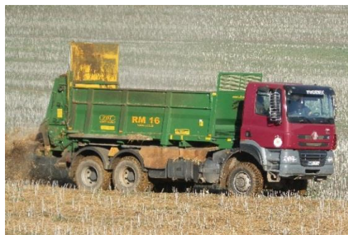
Obrázek 4 – Nástavba pro aplikaci pevných statkových hnojiv při práci (Foto: Milan Hrach)
