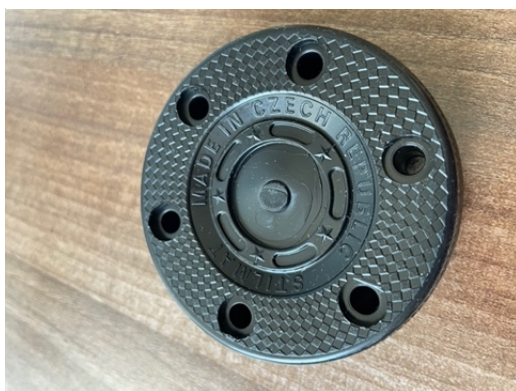
Obr. 14: Polotovar po vyjmutí z formy
