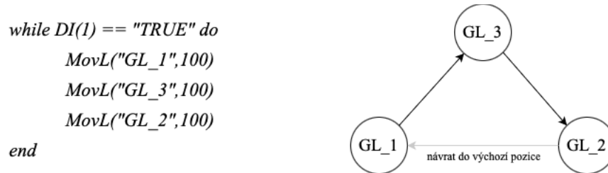
Obr. 51: Vzorový kód trajektorie s parametrem PASS
