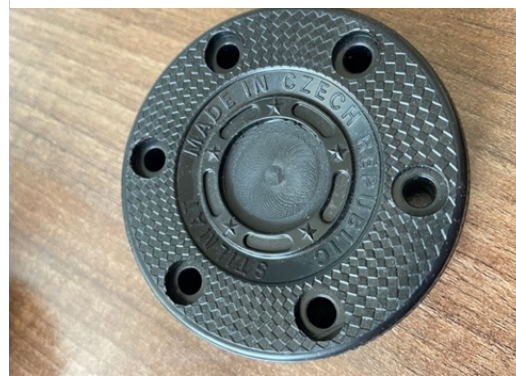
Obr. 15: Polotovar po středovém frézování
