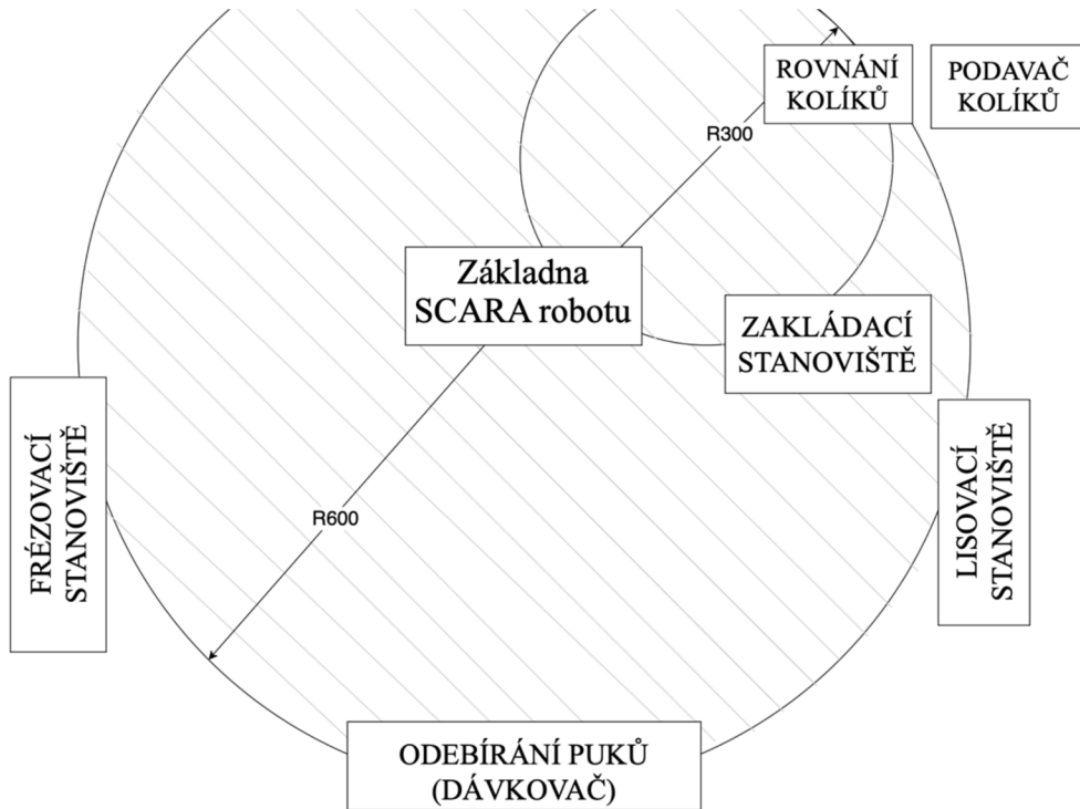
Obr. 18: Rozmístění mechanického uspořádání robotického pracoviště
