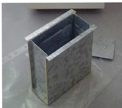
Obrázek 9: nádoba pro vkládání do olejové lázně
