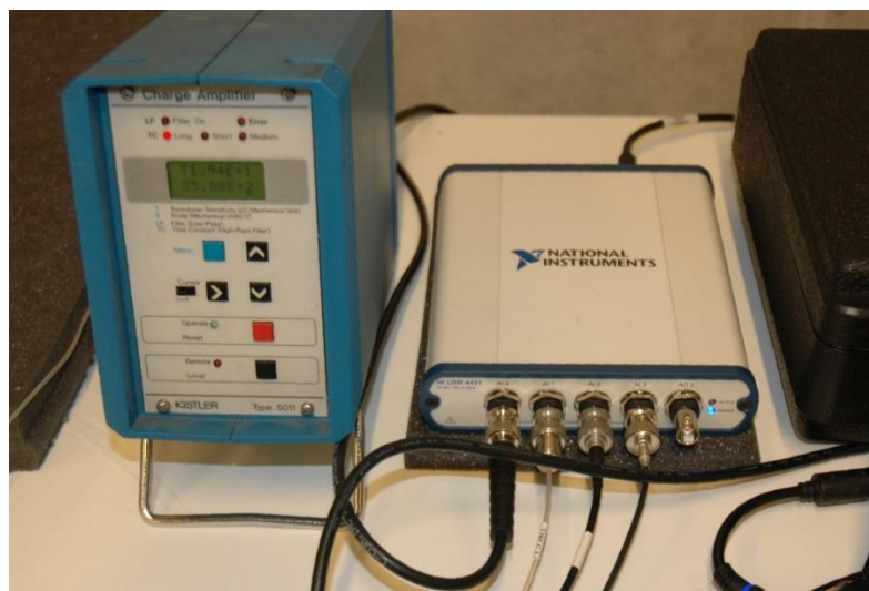
Obrázek 22 - Nábojový zesilovač Kistler 5011 a měřicí karta NI DAQ 9331
