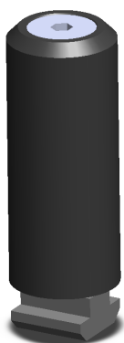
(a) První varianta držáku na závaží ze šroubu a 3D výtisku
